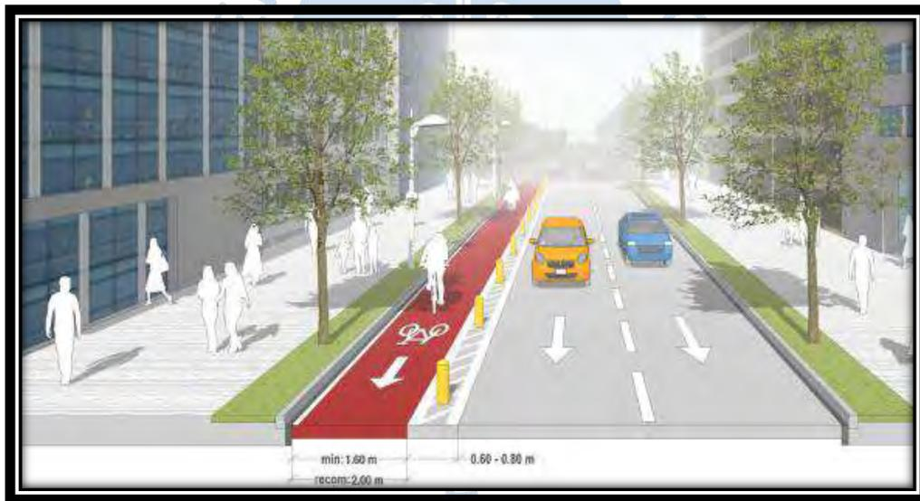
Figura 23. Esquema de ciclovía unidireccional.
