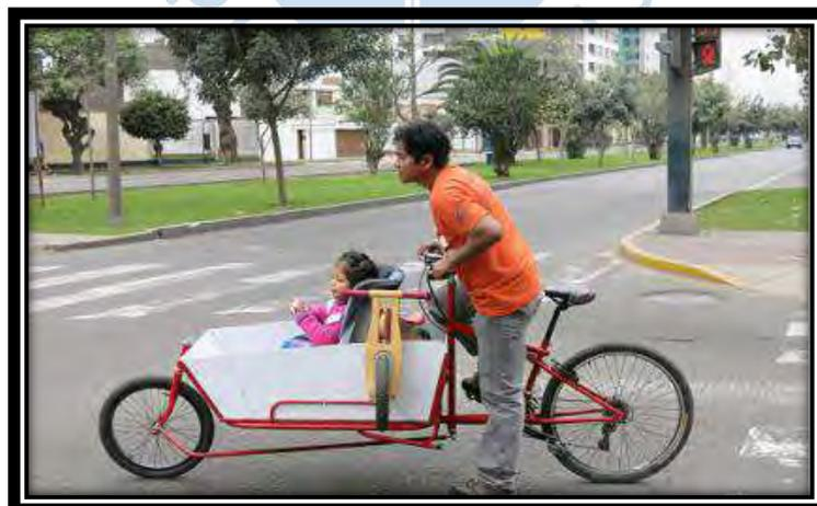
Figura 18. Bicicleta de carga tipo Bullitt.
