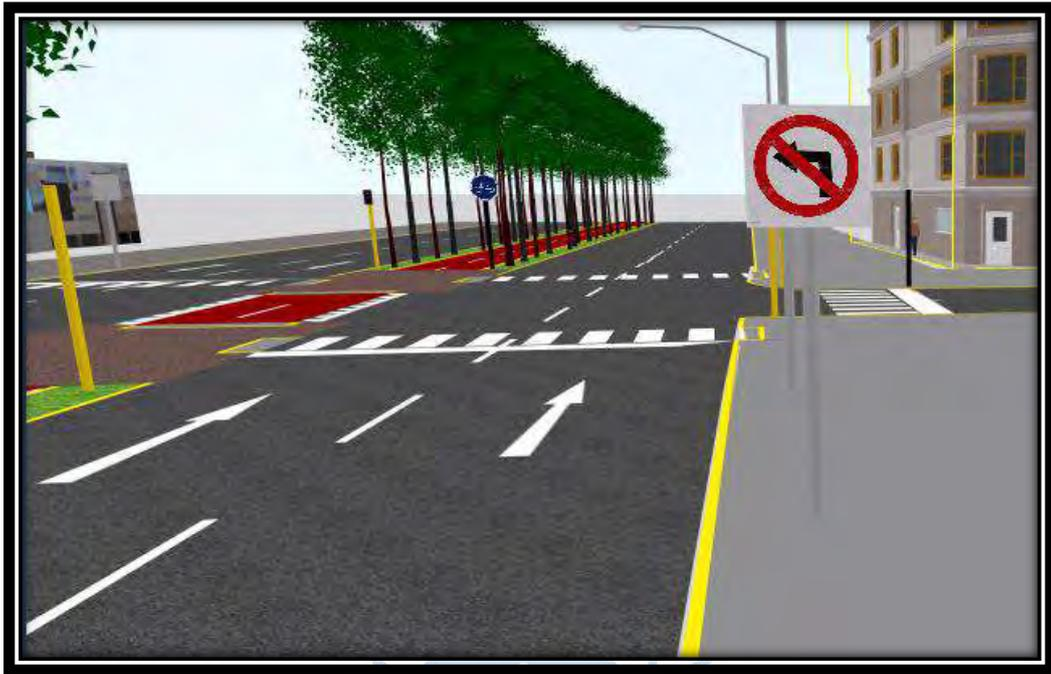
Figura 84. Modelación en Vissim de la señal R-6: Prohibido voltear a la izquierda.
