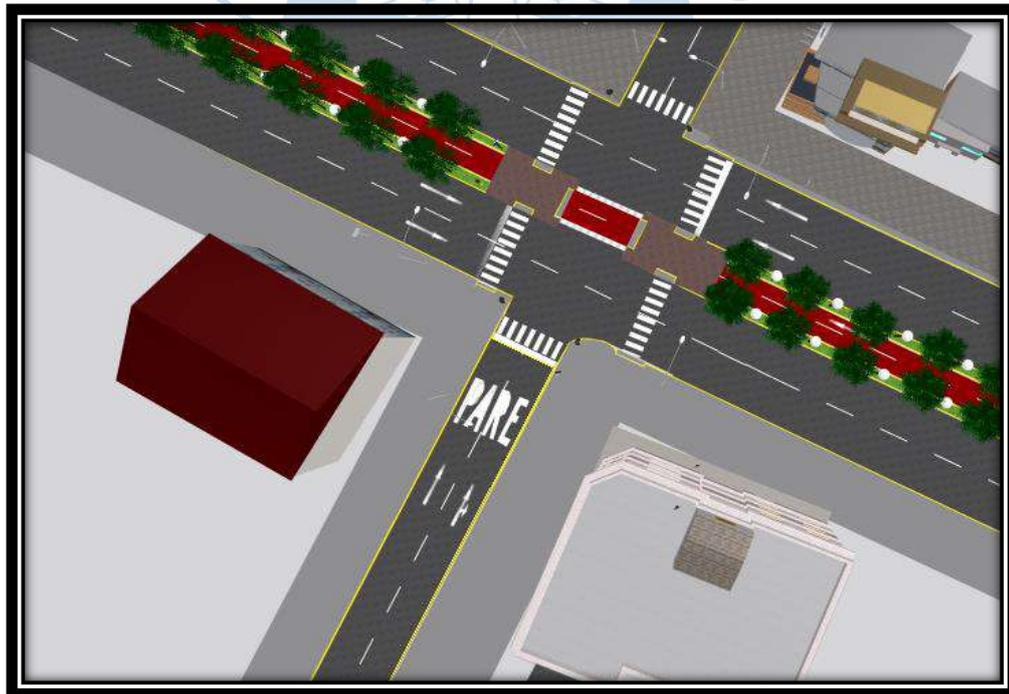
Figura 80. Modelación en Vissim de la Señal de PARE en las intersecciones.
