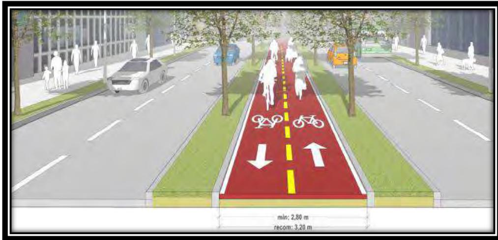
Figura 24. Esquema de ciclovía bidireccional.
