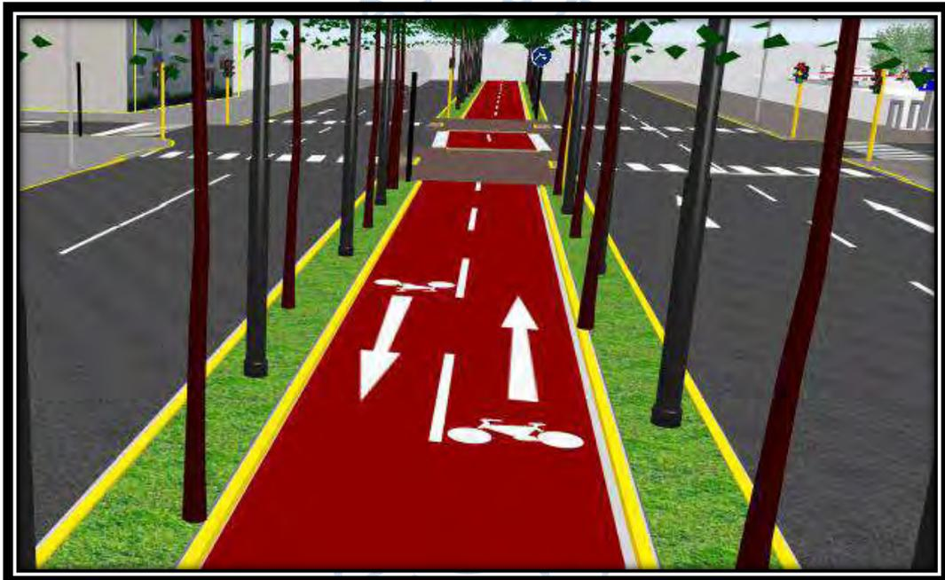
Figura 78. Modelación en Vissim de la demarcación de línea discontinua en ciclovía bidireccional.
