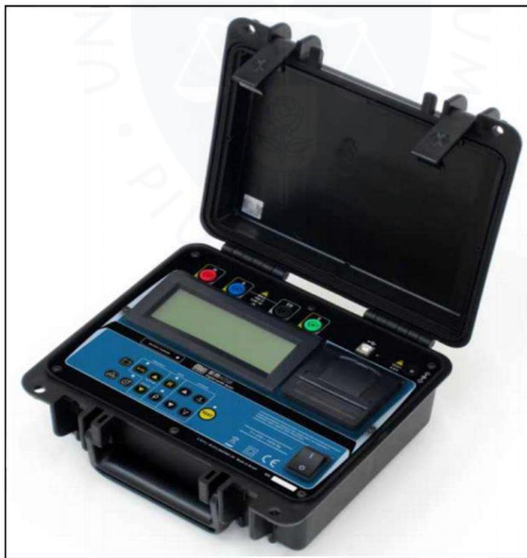
Figura 53. Equipo empleado en las mediciones en campo. Megabras EM-4058. Fuente: Megabras Ind. Electrónica Ltda. (2020).
