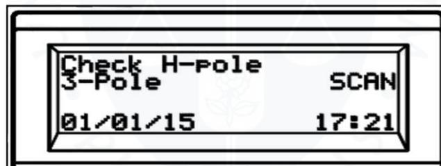
Figura 61. Error sobre revisar un conector.
