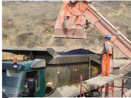
**MEZCLA ASFALTICA EN CALIENTE CON ASFALTO MODIFICADO CON POLIMEROS SBS**
