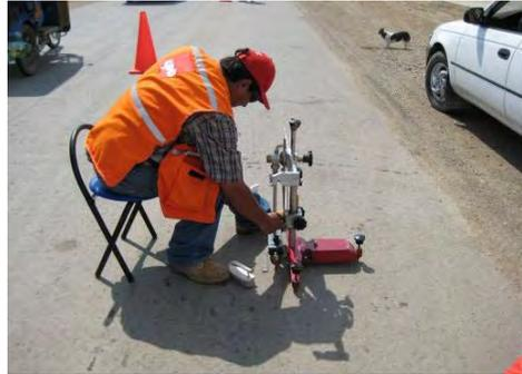
**MEDICION DEL COEFICIENTE DE RESISTENCIA AL DESLIZAMIENTO O MICROTEXTURA CON PENDULO BRITANICO**
