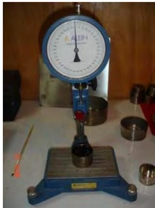
**ENSAYO DE PENETRACION**
