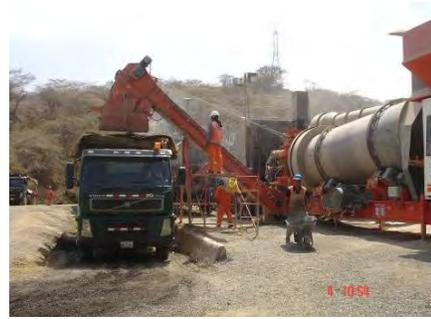
**PLANTA DE ASFALTO A CONTRAFLUJO**
