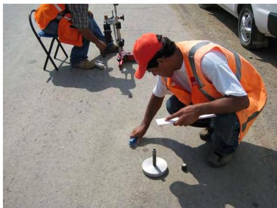
**Medición de la textura superficial o macrotextura mediante el método del círculo de arena**
