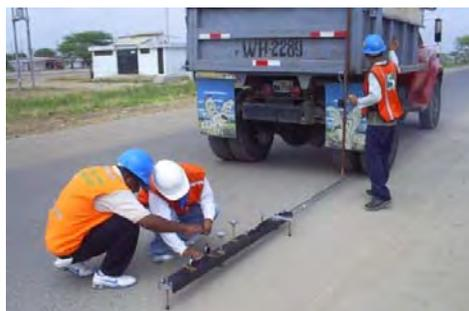
**DEFLECTOMETRIA CON VIGA BENKELMAN**
