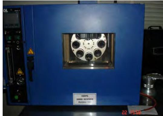
**HORNO ROTATORIO PARA ENSAYO
