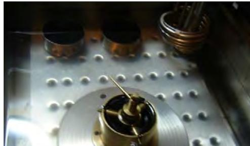
**ENSAYO DE RECUPERACION ELASTICA POR TORSION**
