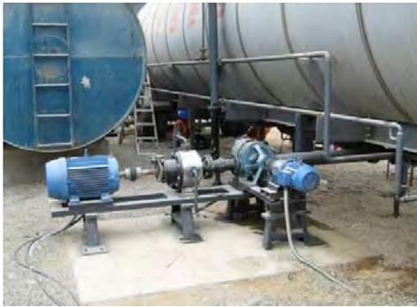
**MOLINO COLOIDAL Y BOMBA DE ASFALTO**
