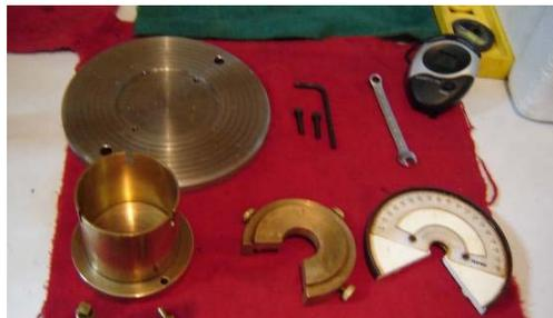
**EQUIPO PARA ENSAYO DE RECUPERACION ELASTICA POR TORSION SEGÚN NORMA ESPAÑOLA NLT-329-91**
