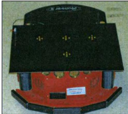
Figura 2. Configuración de balizas en T.
