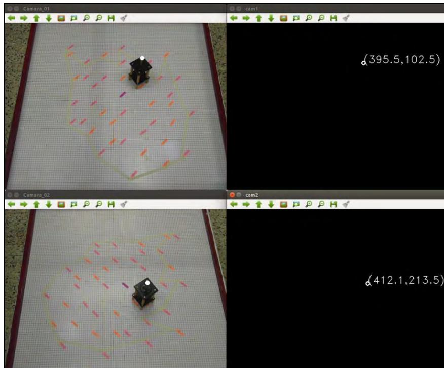
Figura 80. Detección del marcador en ambas cámaras (a). Seguimiento del marcador detectado (b). - Punto 1.
