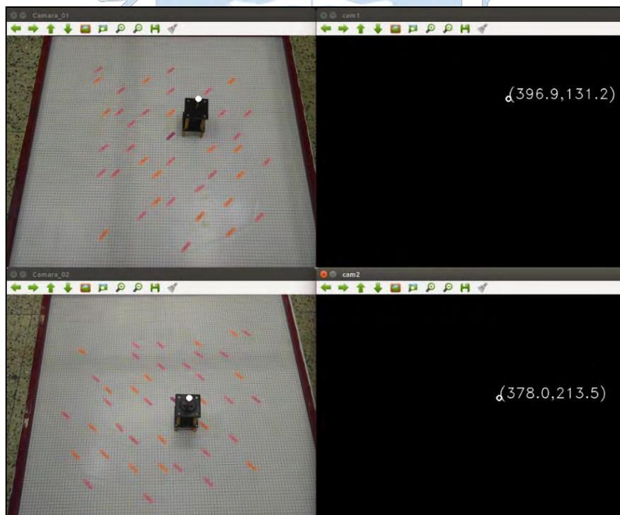
Figura 81. Detección del marcador en ambas cámaras (a). Seguimiento del marcador detectado (b). - Punto 2.
