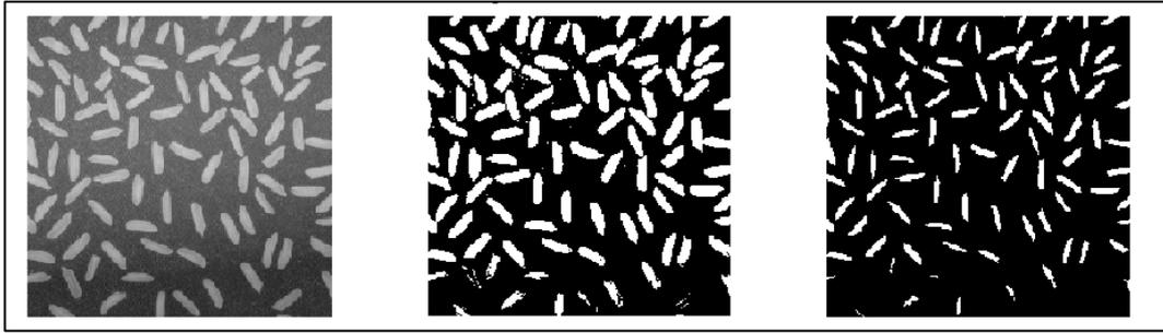
Figura 30. Efecto de degradación en una imagen al aplicar una transformación morfológica de erosión binaria con disco de radio 2 como elemento estructurante.
