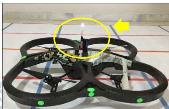
Figura 9. Implementación de un LED en la parte superior de un dron para la determinación de su posición.
