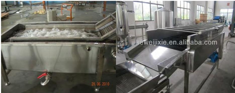
**Figura 14. Máquina Lavadora- Cepilladora**
