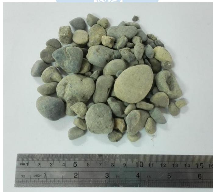
Figura 8. Muestra de agregado grueso
