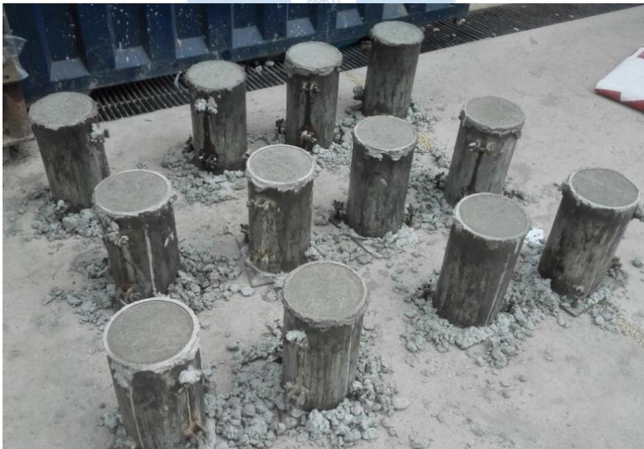
Figura 12. Probetas obtenidas del procedimiento LEMC
