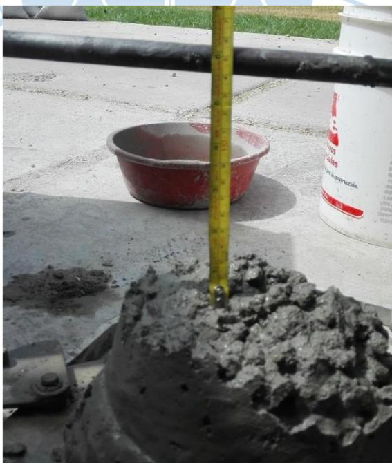
Figura 38. Asentamiento de la tanda de comprobación del proceso modificado
