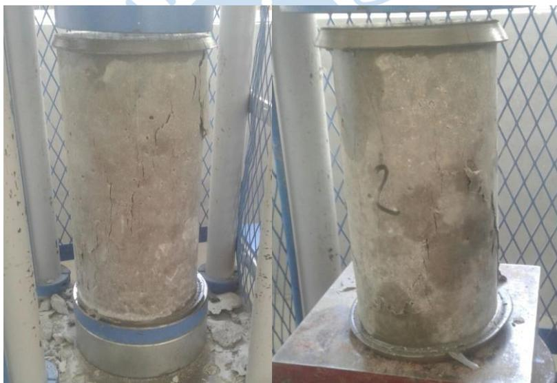
Figura 29. Tipo de falla en probeta 15x30cm y 10x20cm.
