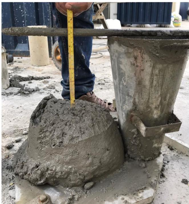
Figura 26. Ensayo de slump – Procedimiento modificado.
