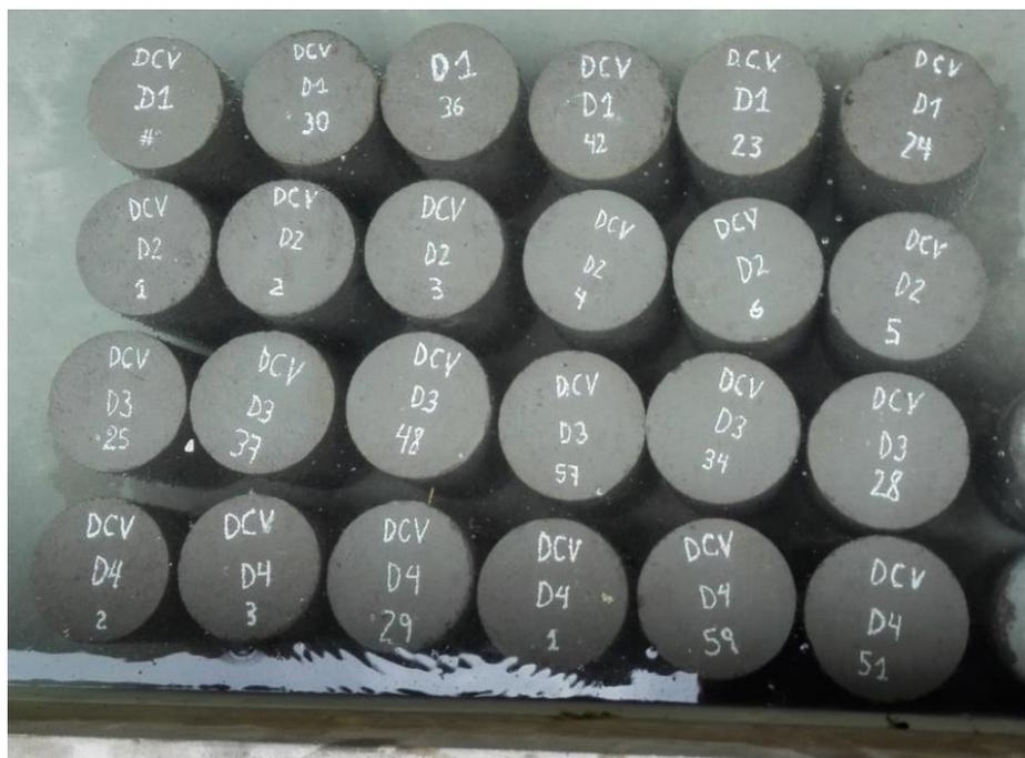
Figura 17. Proceso de curado de probetas 10x20cm
