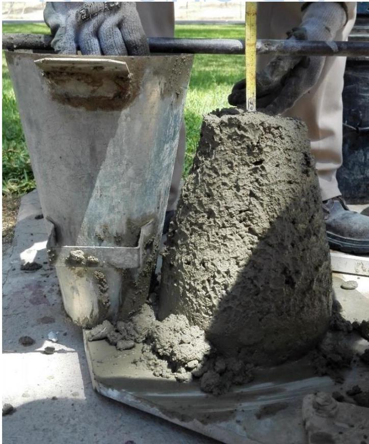
Figura 24. Ensayo de slump – Procedimiento LEMC.
