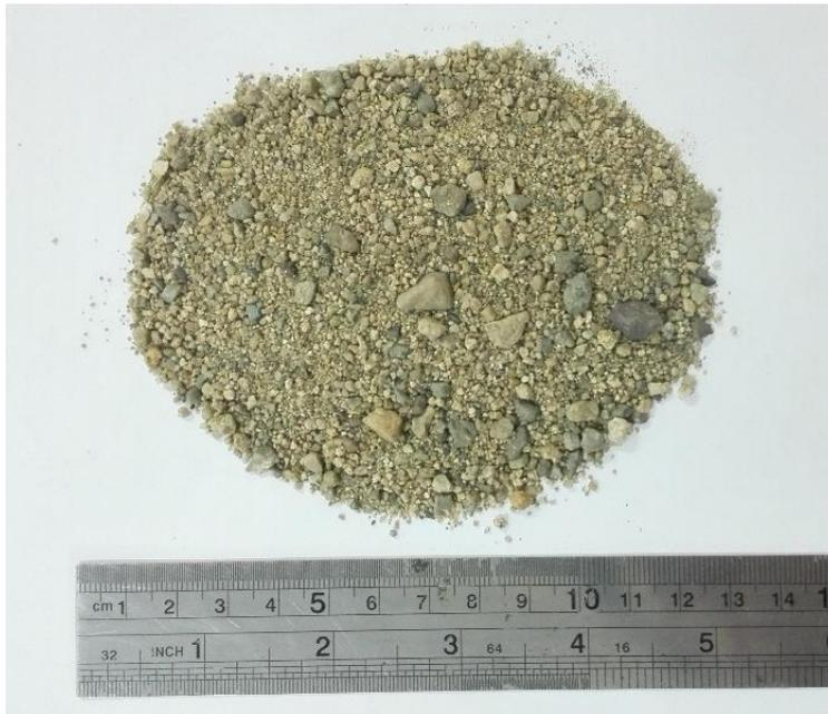
Figura 5. Muestra de agregado fino
