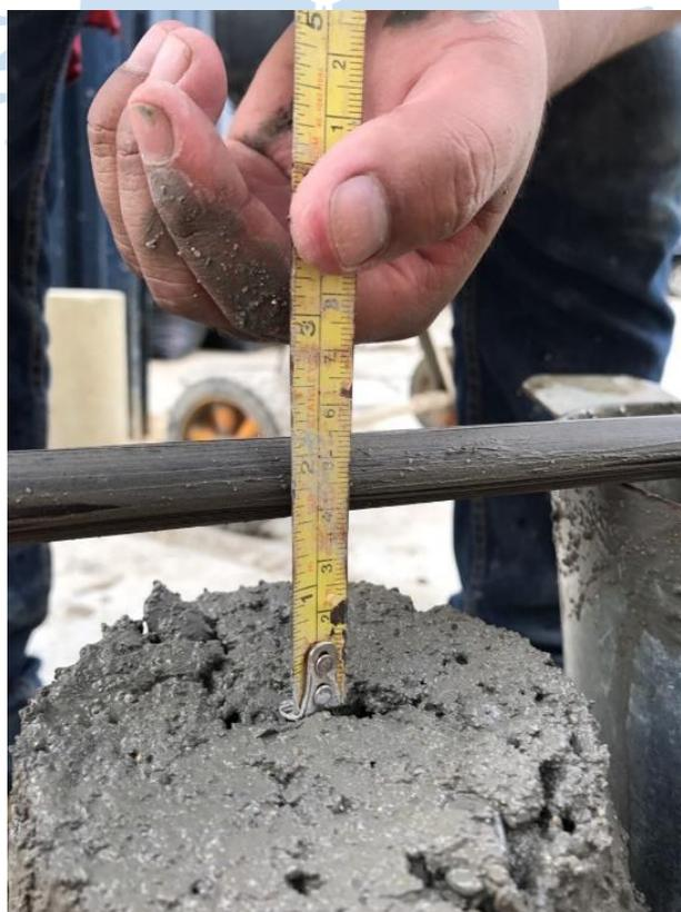
Figura 36. Ensayo de asentamiento tanda de comprobación LEMC
