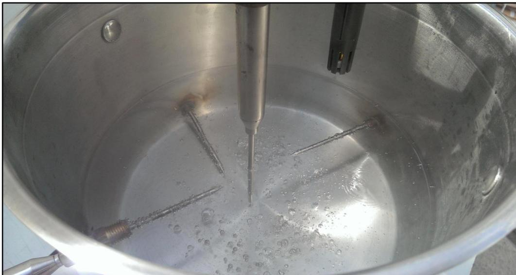
Figura 1. Fotografía del arreglo de sensores PT-100 en pruebas con agua
