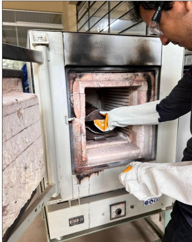
**Vertido del material fundido.** Luego de verificar la correcta fundición de las tapas de plástico, se extrajo el material con una espátula y se esparció en el molde para ser posteriormente prensado.
