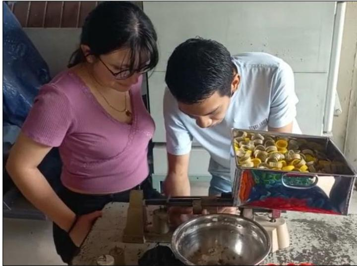
**Fundición del polipropileno.** En este proceso se colocaron las tapas dentro de la bandeja en un horno precalentado a 200°C.
