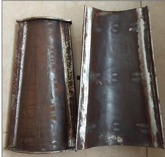
Dado que la presencia de material oxidado en el interior del molde generaba problemas al momento de moldear el plástico, se tuvo que realizar un pulido con una amoladora, utilizándose discos Bosch de grano 80 para eliminar el óxido y luego un disco de grano 120 para un pulido más completo. Además, se utilizaron hojas de papel de lija de grano 120 para las áreas de difícil acceso de los discos.
