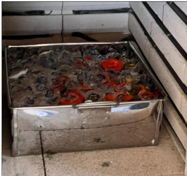
**Calentamiento del molde.** Para esta etapa del proceso se colocó el molde en un horno calentado a 230°C.
