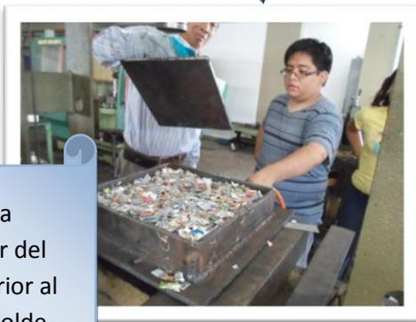
Colocado de la parte superior del molde, posterior al llenado del molde.
