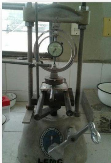
Ilustración 221. Máquina compresora
