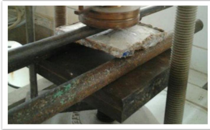
Ilustración 220. Rodillos de apoyo debajo del prototipo
