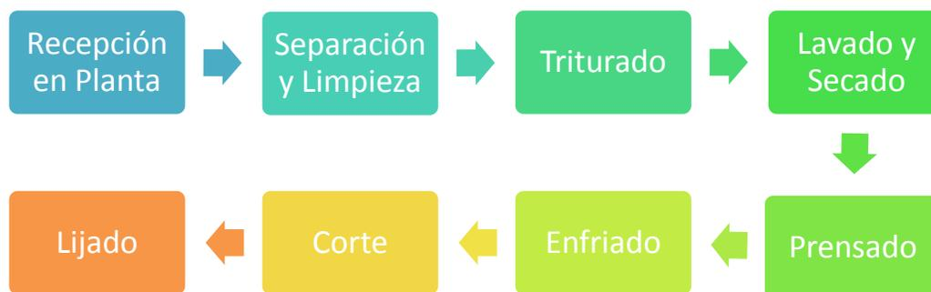
Ilustración 42. Diagrama del Proceso
