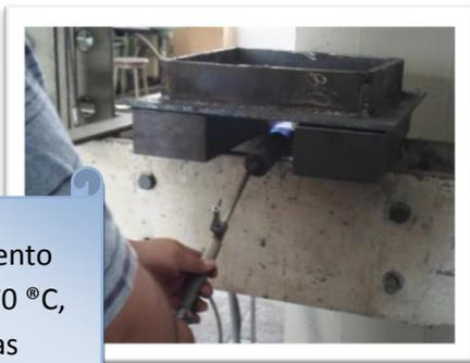
Proceso de calentamiento de la prensa. Hasta 170 °C, utilizando soplete a gas
