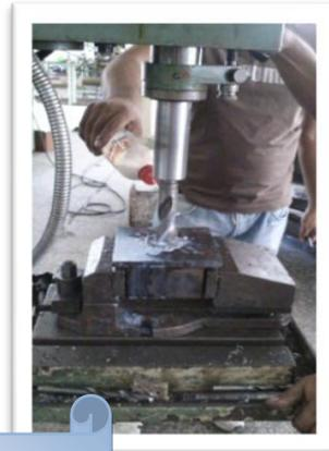
Perforación de la base para facilitar extracción del prototipo
