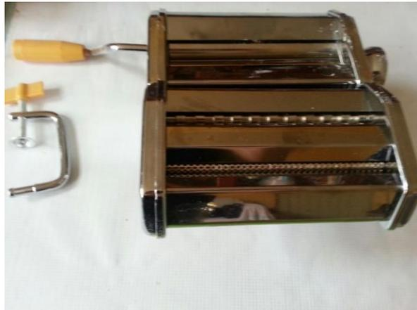
**Figura 13.** Máquina cortadora de fideos
