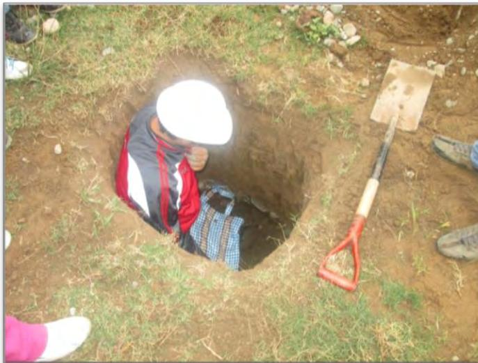
**Fig. 5.2** Pozo de exploración a cielo abierto
