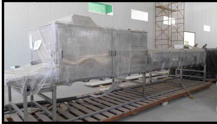
Figura 23. Túnel de enfriamiento Duyvis Wiener
