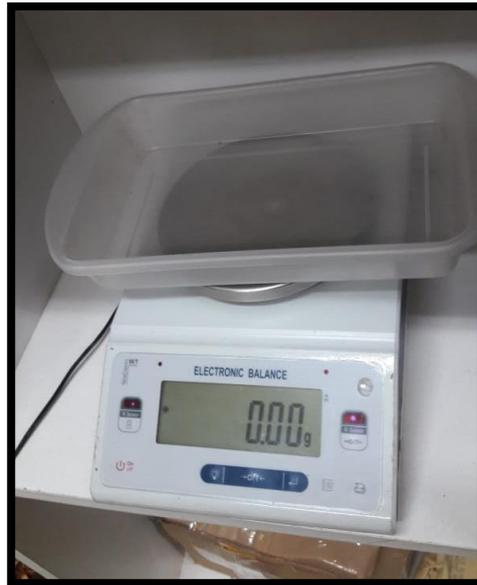
Figura 25. Balanza de dos decimales
