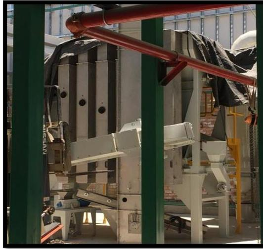
*Figura 16. Esterilizador en instalación Duyvis Wiener*
