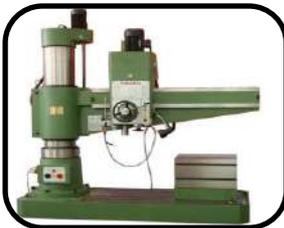
**Descripción:** Se compone de una amplia base horizontal sobre la que generalmente se halla dispuesta la mesa porta piezas fija, con sus guías para que en ellas puedan colocarse tornillos para fijación de las piezas que se ha de taladrar .
