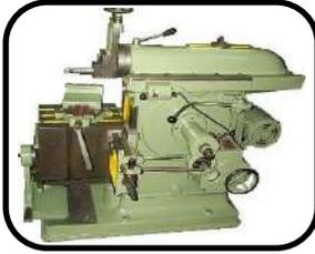
**Descripción:** Máquina herramienta para generar superficies planas, sus movimientos principales son en tres ejes: horizontal, vertical y transversal; una combinación de estos movimientos puede generar superficies curvas .
