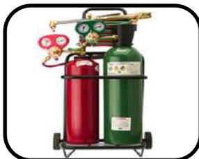
**Descripción:** Es un sistema de soldadura y corte que se caracteriza por la utilización de un soplete y gases (acetileno y oxígeno), en un estado comprimido. Se compone de botellas con gas combustible, soplete de oxicorte o cortador, mangueras flexibles, manómetros o manorreductores y válvulas antirretorno o antirretroceso.
