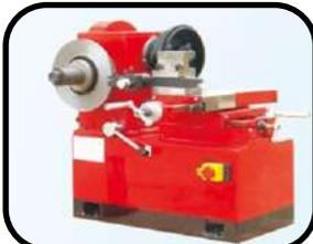
**Descripción:** Corrigen con facilidad las áreas de espesor o imperfecciones de discos y tambores, un problema habitual causado por el contacto desigual de las zapatas o pastillas de frenos en la superficie de fricción.
