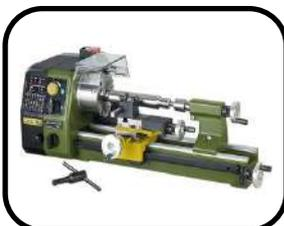
**Descripción:** Máquina herramienta que permite mecanizar piezas de forma geométrica (cilindros, conos) Estos dispositivos se encargan de hacer girar la pieza mientras las herramientas de corte son empujadas contra su superficie, cortando las partes sobrantes en forma de viruta.
