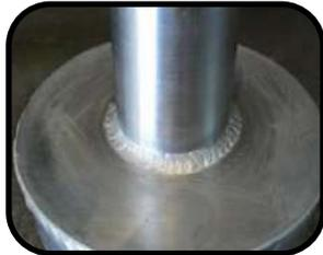
**Servicios ofrecidos:** Se utiliza en casi cualquier tipo de metal. Se puede usar en metales de espesor delgado, no calienta la superficie, por tanto no produce deformación. Se utiliza en general cuando se quiere lograr calidad y buen acabado de las soldaduras.
