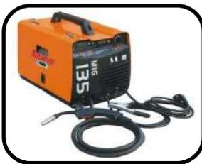
**Descripción:** Máquina con un proceso en el que la fusión se produce por un arco establecido entre el extremo de un electrodo consumible y la pieza a soldar. La protección se obtiene de los gases suministrados simultáneamente con el metal de aporte. Si se trata de un gas inerte, se conoce como soldadura MIG; si se trata de un gas activo, se denomina soldadura MAG.
