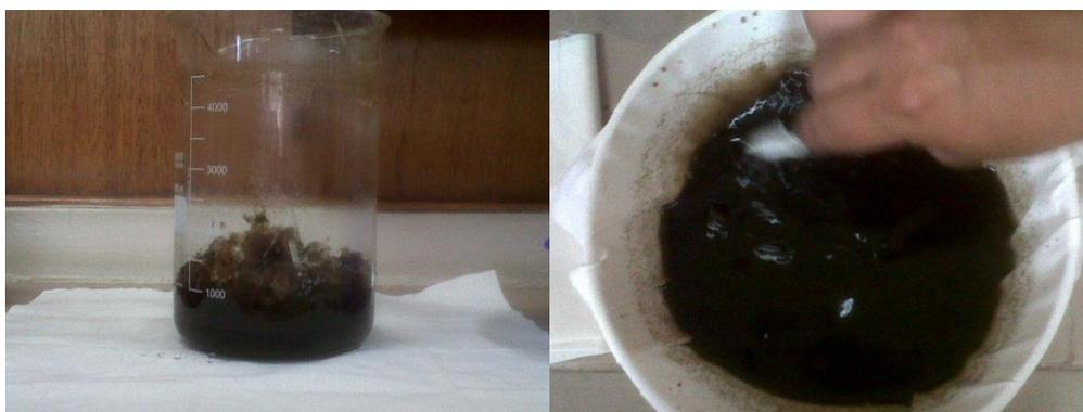
**Figura 3: Cristales de sulfato de sodio sedimentados en el vaso de precipitado y filtración de la solución**
