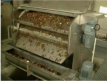
ILUSTRACIÓN 15: TAMIZ ROTATIVO FUNCIONAMIENTO
