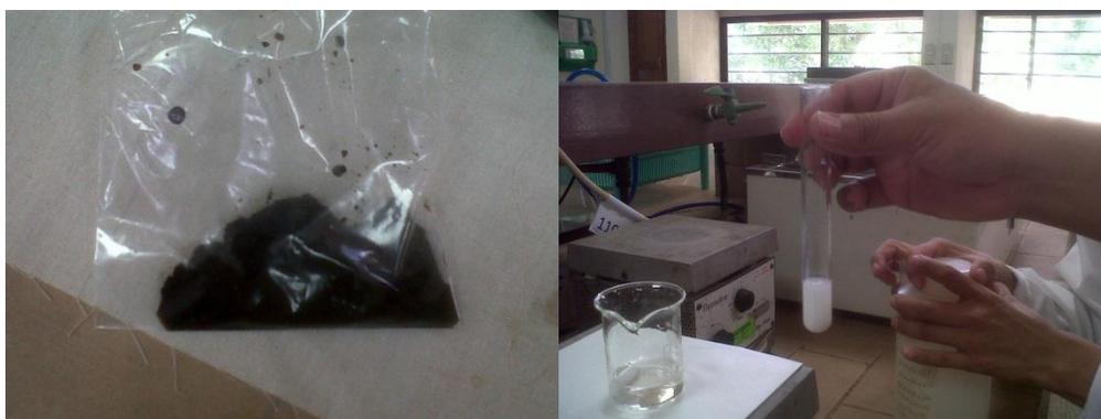
**Figura 6: Torta residuo de la filtración y valoración de los cristales**
