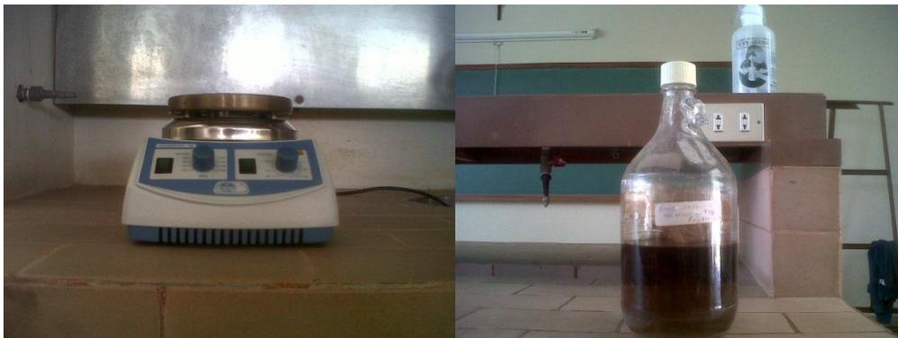
**Figura 1: Agitador magnético con calentador y ácido sulfúrico para la deslignificación**
