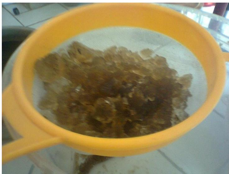
ILUSTRACIÓN 27 CRISTALES DE SULFATO DE SODIO. FUENTE: LABORATORIO DE QUÍMICA - UDEP.
