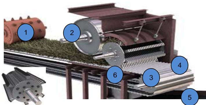
ILUSTRACIÓN 9: DESFIBRADORA PESADA EN LÍNEA ILUSTRACIÓN 10: ROTOR DE 6 CABEZAS
