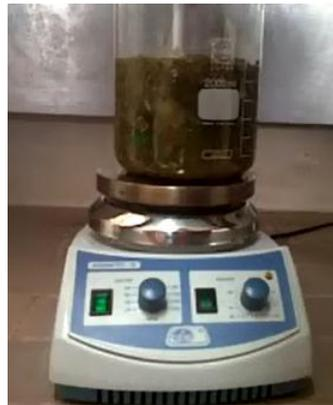
ILUSTRACIÓN 22: AGITADOR MAGNÉTICO CON CALENTADOR. FUENTE: LABORATORIO DE QUÍMICA – UDEP
