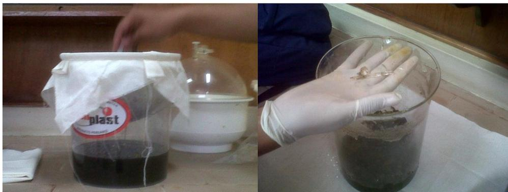
**Figura 4: Proceso de filtración y cristales sedimentados en el vaso precipitado**
