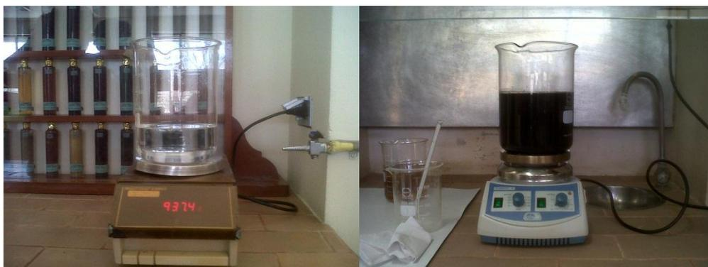
**Figura 2: Vaso precipitado tarado y solución en el agitador**
