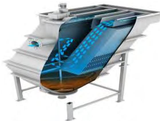
**Figura 2. Equipo de coagulación floculación**
