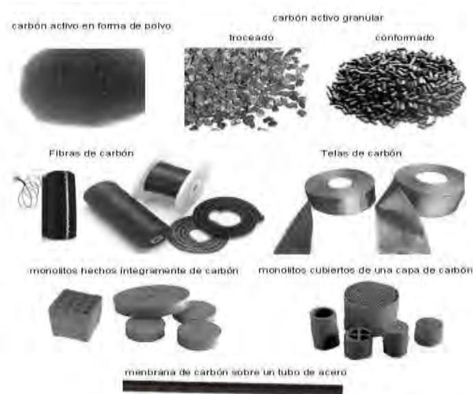
**Figura 6.** Diferente formas de carbón activado
