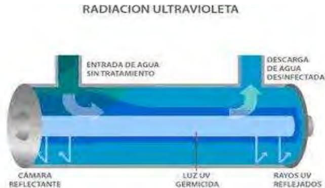
**Figura 13.** Parte interna de un esterilizador UV
