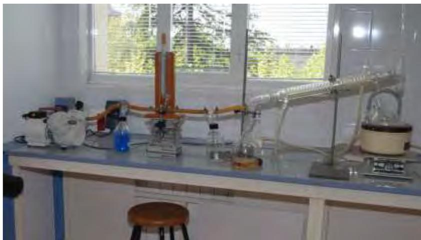
**Figura 9.** Equipo de destilación de laboratorio
