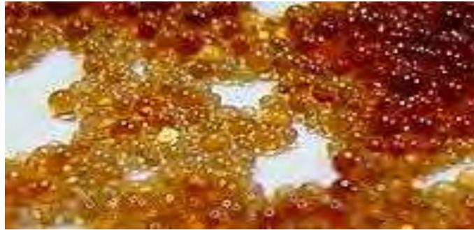
**Figura 17. Resinas de intercambio iónico**
