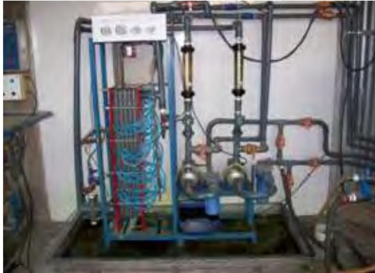
**Figura 20.** Equipo de electrodiálisis
