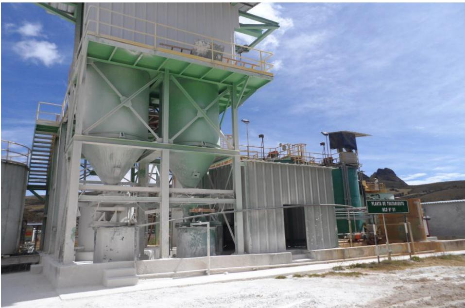
Figura 16. Vista de la preparación y dosificación de pulpa de caliza y cal
