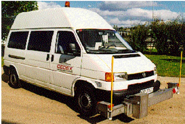
**Figura 2.4 Perfilógrafo de alto rendimiento\***
