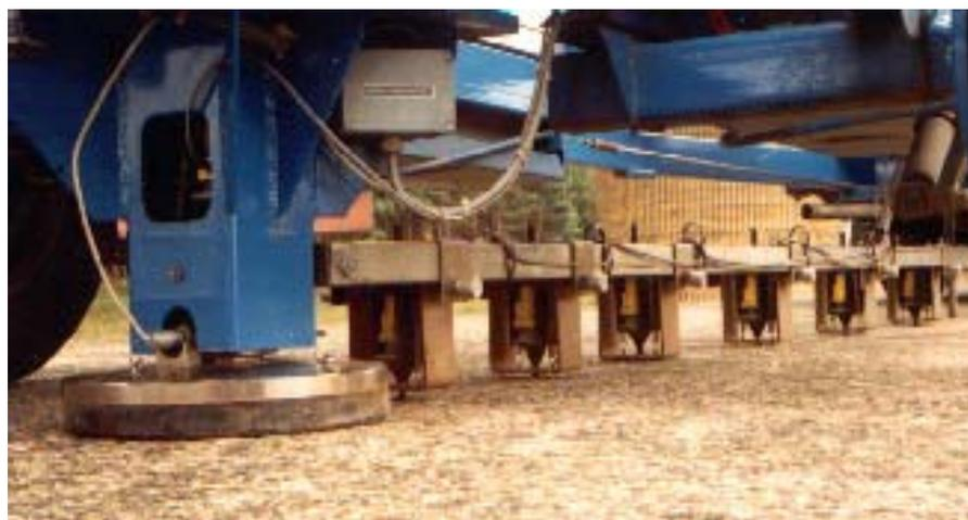
**Figura 2.7 Distribución del plato de carga y de los sismómetros\***
