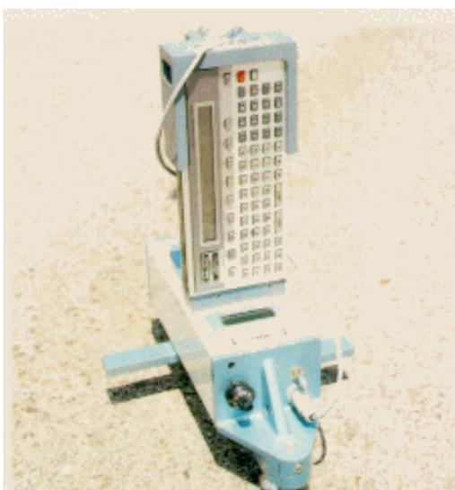
Figura 2.5 Perfilómetro pivotante \*
