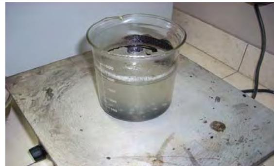
**3er paso:** Adición de 400 ml. de agua destilada en un beaker de 600 ml., puesto en un "Plato Caliente", para ebullición a 100°C.
