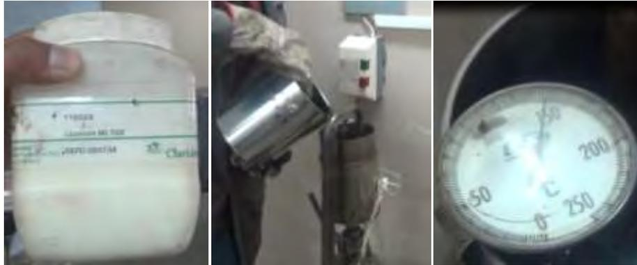
**Fig. 3.2 Elaboración de asfalto emulsificado**
