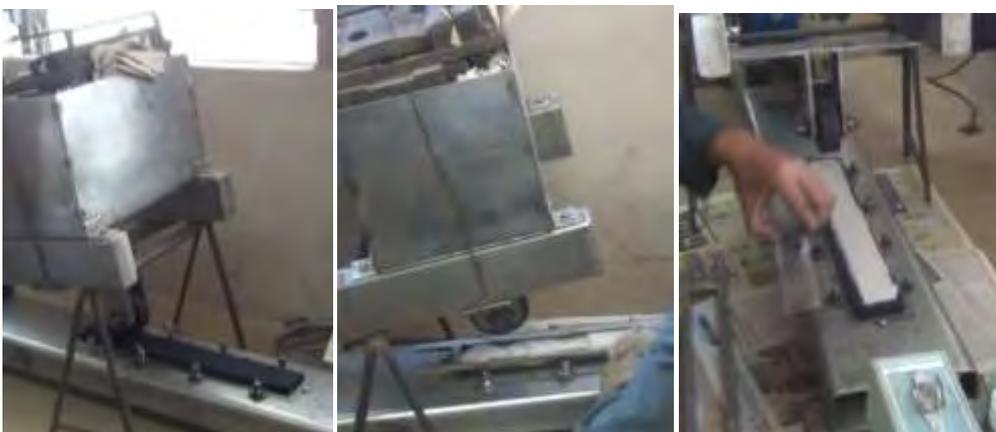
**Fig. 3.13 Máquina de la rueda cargada LWT**
