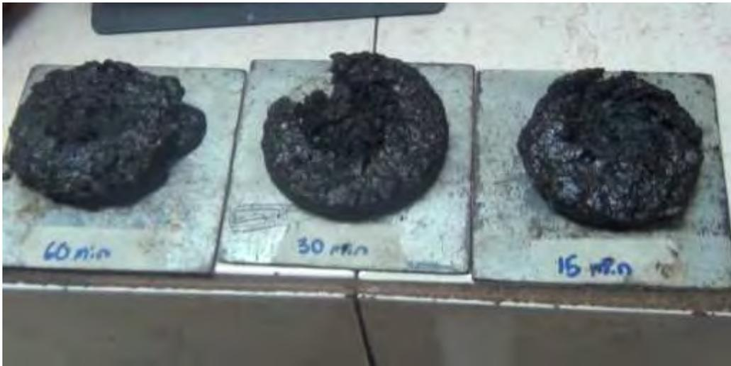
**Fig. 3.8 Pastillas ensayadas para porcentaje teórico de *filler***
