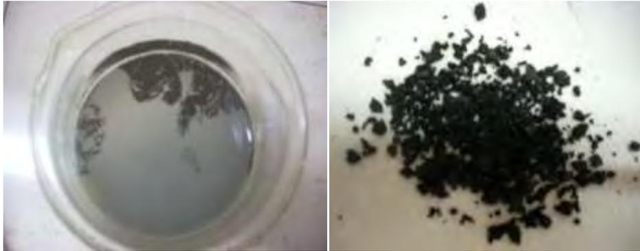
**Fig. 3.10 Recubrimiento de la emulsión en el agregado 2**
