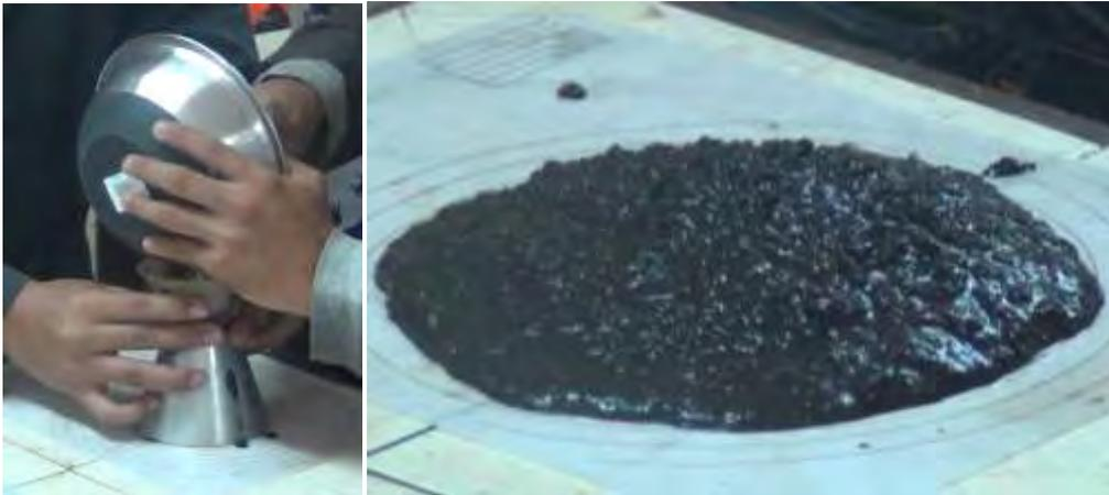
**Fig. 3.6** Porcentaje óptimo de humedad en la mezcla
