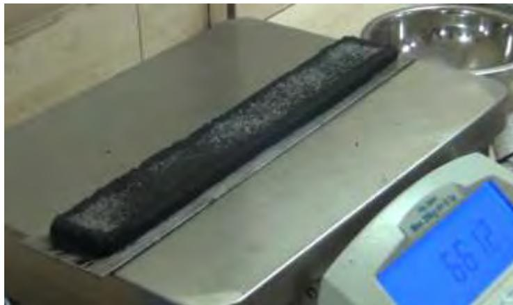
**Fig. 3.15 Muestra ensayada, rueda cargada LWT**
