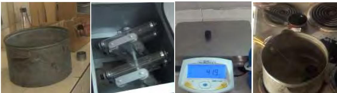
Fig. 3.17 Ensayo de *Schulze Breuer*
