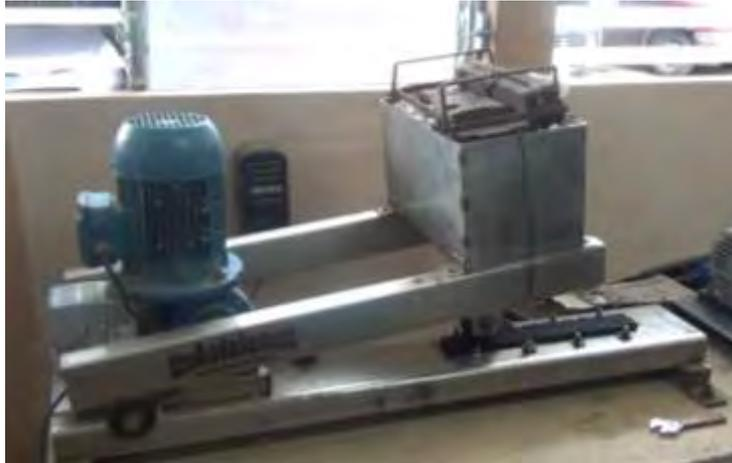
**Fig. 3.14 Ensayo de la rueda cargada LWT**
