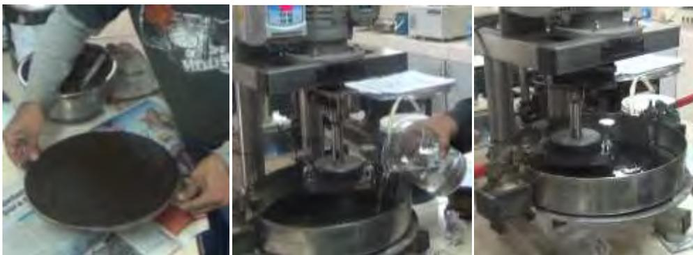
**Fig. 3.11 Muestras y ensayo de WTAT**
