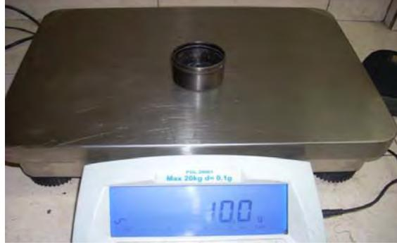
**1er paso:** Muestra representativa de Mezcla Curada, proveniente del ensayo ISSA TB-106, de MicroSurfacing Tipo III.
