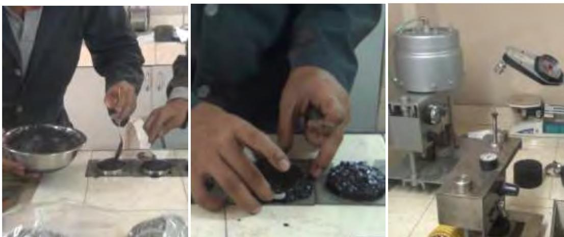
**Fig. 3.7** Elaboración de pastillas para porcentaje teórico de *filler*
