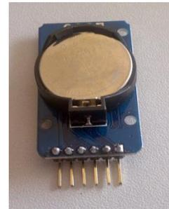
Figura 54. Reloj digital con pila compatible con Arduino.
