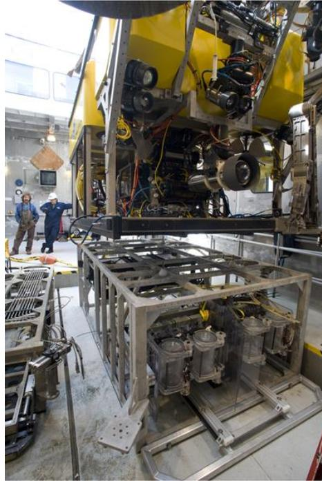
Figura 20. Midwater Respirometry System (MRS) Respirómetro y Grúa capaces de realizar mediciones en el habitat natural de los animales acuáticos, un respirómetro es el instrumento usado en estudio de la respiración de los langostinos así como de otros animales.
