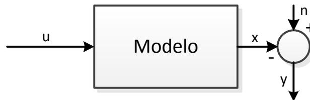
Figura 24: Modelo matemático usado por EPSAC.
