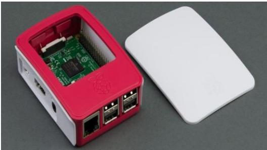
Figura 52. Raspberry Pi III, incluye case para protección y disipadores de calor producido por el micro procesador.
