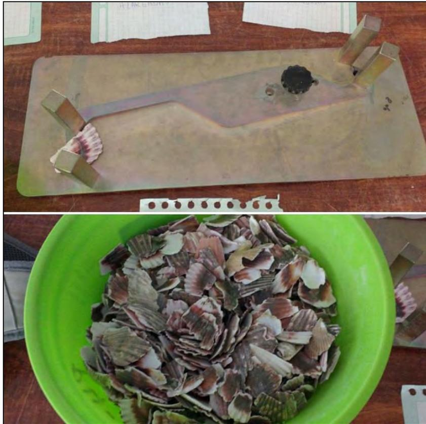
**Figura 2.17** Ensayo de Partículas chatas y alargadas. Fuente: Elaboración propia.
