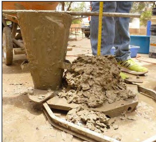
**Figura 3.14. Ensayo de slump con el diseño CAF-3. Fuente: Elaboración propia.**
