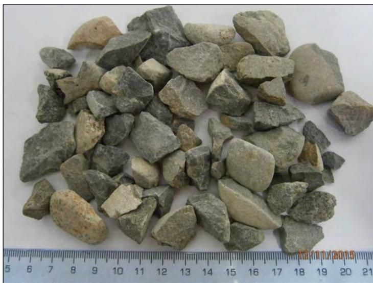
**Figura 3.3 Agregado Grueso Triturado. Fuente: Elaboración propia.**
