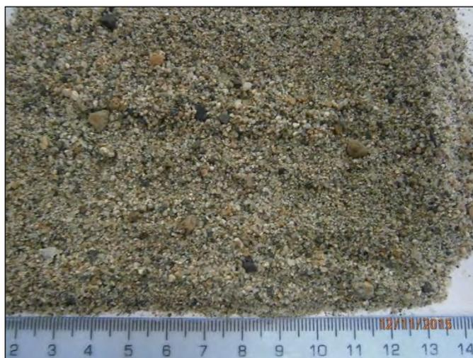
**Figura 3.6 Agregado fino. Fuente: Elaboración propia.**
