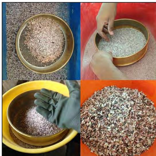
**Figura 2.3. Proceso de tamizado de residuos de concha de abanico triturados. Fuente: Elaboración propia.**
