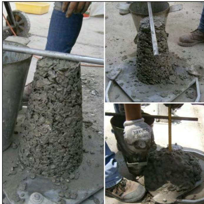
Figura 3.10 Ensayo de Trabajabilidad. Izquierda, diseño CFT. Derecha y arriba, diseño CAF. Derecha y abajo, diseño AAF.
