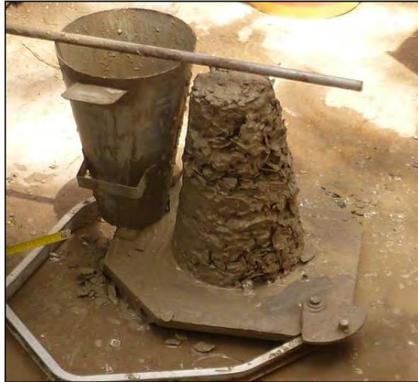
**Figura 3.13. Ensayo de Slump con Diseño CAF-2. Fuente: Elaboración propia.**
