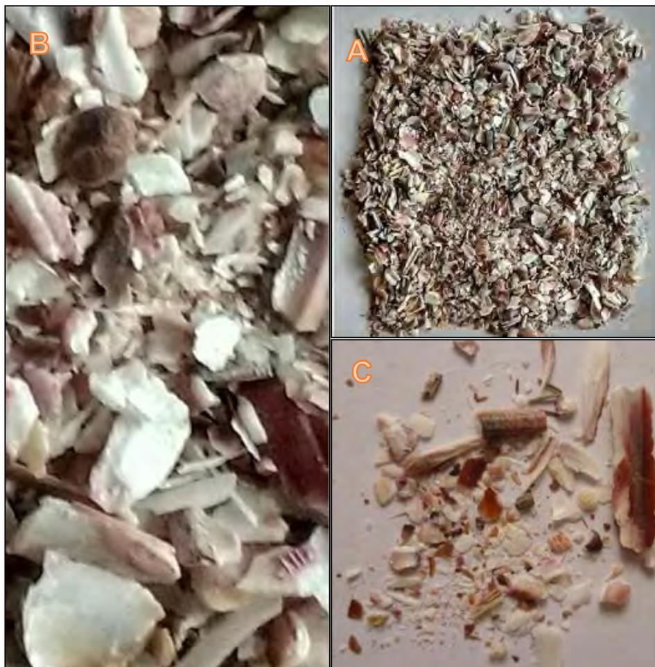
**Figura 2.16 A. RCA como agregado fino (Partículas que pasan el tamiz #4 y son retenidas en el tamiz #200).**
