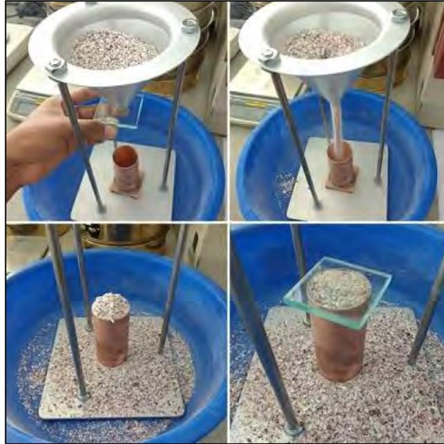
**Figura 2.15. Proceso de Ensayo de angularidad con residuos de concha de abanico.**
