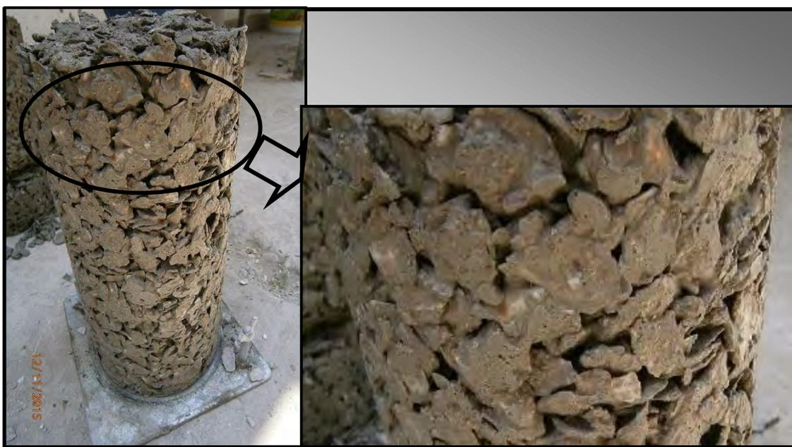
**Figura 3.11 Mezcla de concreto diseñada con curva Fuller y Thompson usando sólo conchas de abanico (CFT). Fuente: Elaboración propia.**
