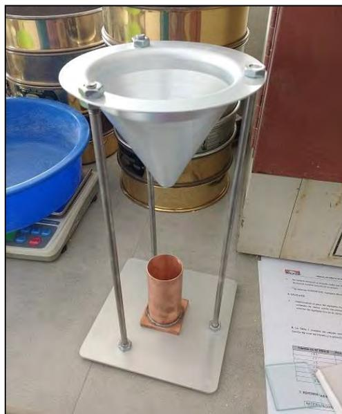
**Figura 2.14** Equipo de ensayo de angularidad. Fuente: Elaboración propia.
