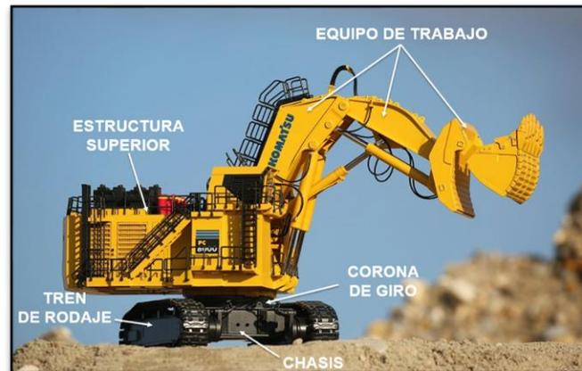
Figura 5. Componentes de una excavadora hidráulica
