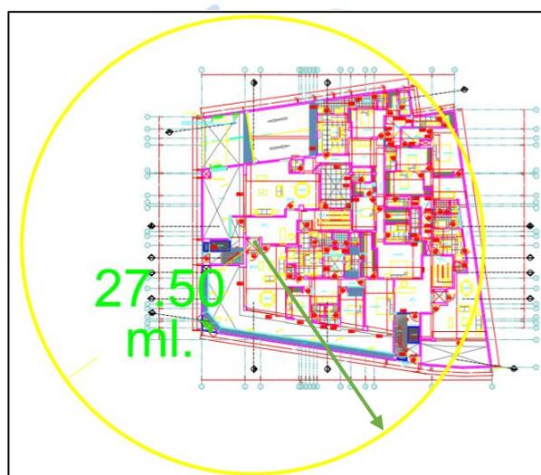
**Figura 20.** Radio de acción de la torre grúa.
