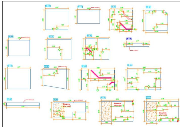
**Figura 13.** Ejemplo de detalle de prelosas aprobadas para su elaboración.
