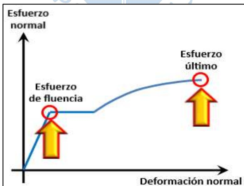
**Figura 27. Curva esfuerzo-deformación del acero**
