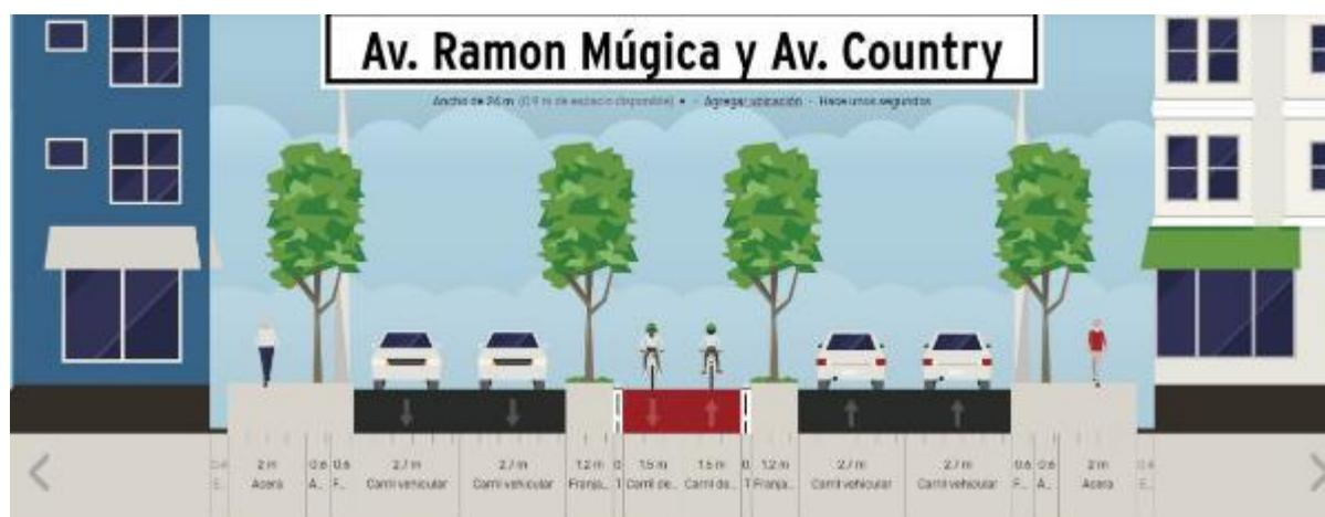
Figura 26. Derecho de vía de la Av. Ramón Múgica y Av. Country - ciclovía bidireccional.
