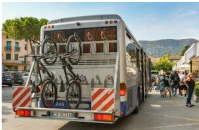
Figura 43. Modelo de bus con rack para bicicletas
