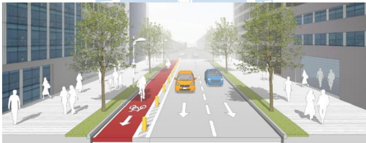
Figura 24. Ejemplo de ciclovía parcialmente segregada unidireccional
