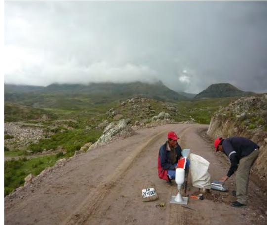
**Foto 4.10 – Ejecución de las pruebas de densidad de campo.**
