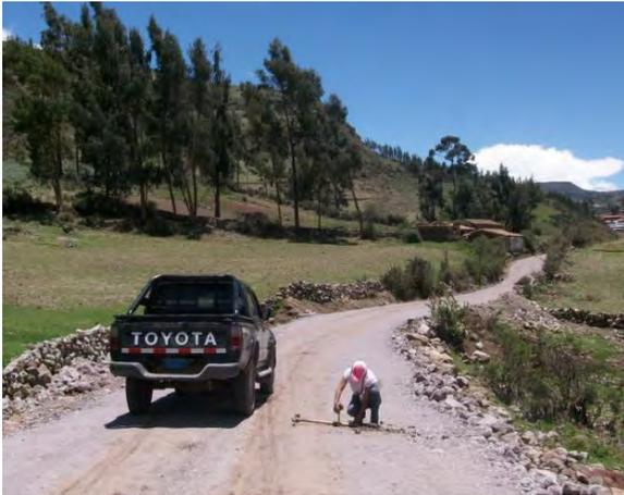
**Foto 4.9 – Medición de espesores del pavimento.**
