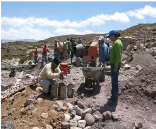
Foto 4.29 - Sacando briquetas del concreto.
