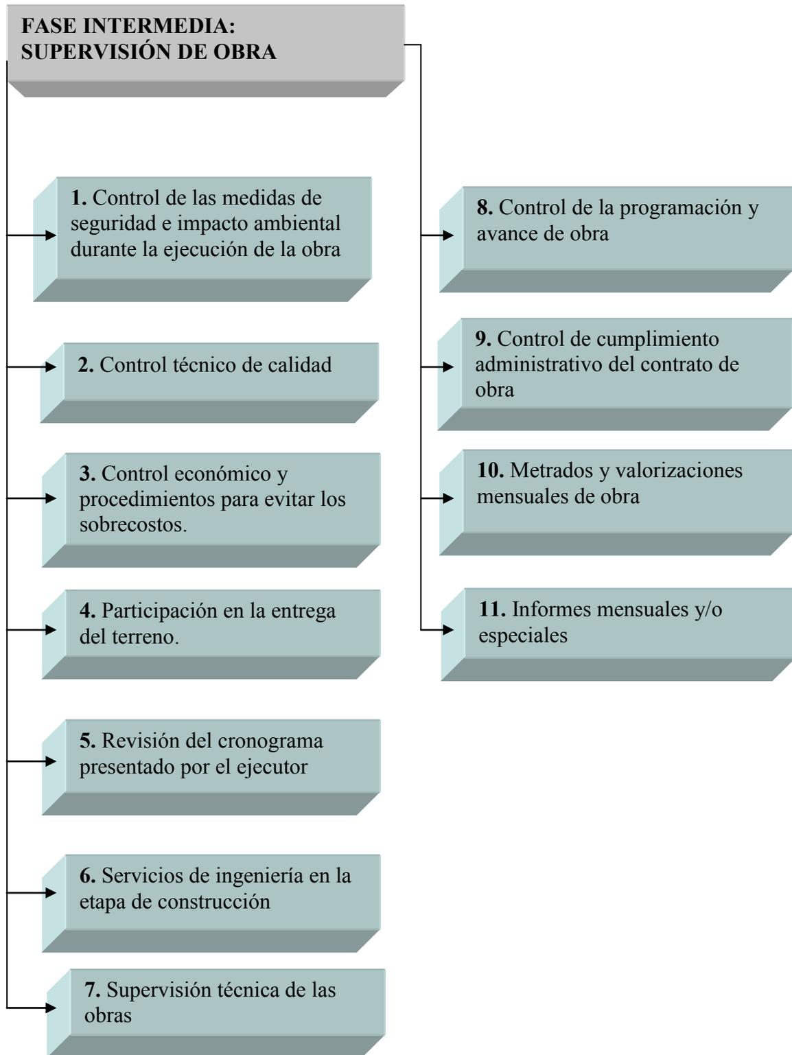
**Figura 1.7 - Esquema del plan de actividades detalladas que la supervisión debe desarrollar durante la ejecución de obra.**
