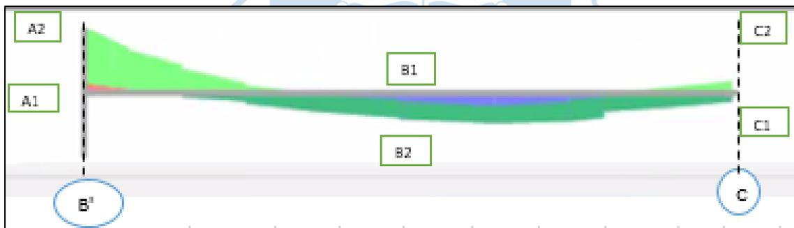
Figura 10. Diagrama de momento flector viga B'-C
