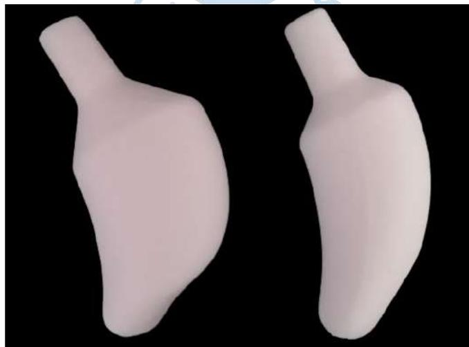
**Figura 111.** Prototipos de PLA del vástago V3.
