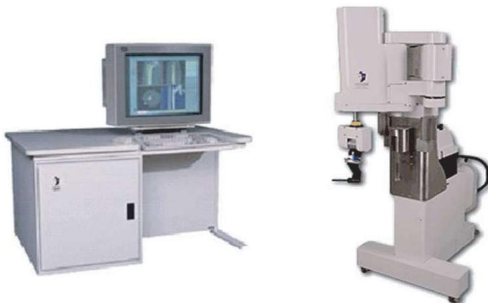
**Figura 5.** Estación de trabajo de planificación preoperatoria y el asistente quirúrgico ROBODOC.
