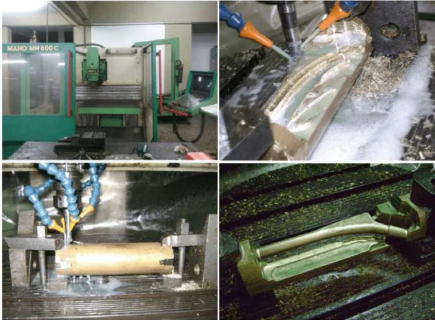
**Figura 12.** Fabricación de un vástago femoral personalizado en la Universidad de Piura.
