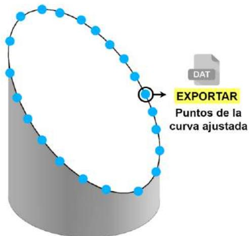
Introduce en NX los puntos de la curva ajustada para obtener la elipse utilizando la herramienta spline
