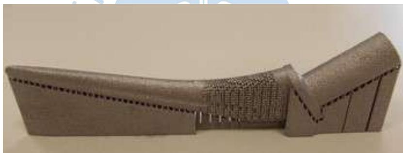
**Figura 4.** Vástago fabricado utilizando tecnología aditiva.
