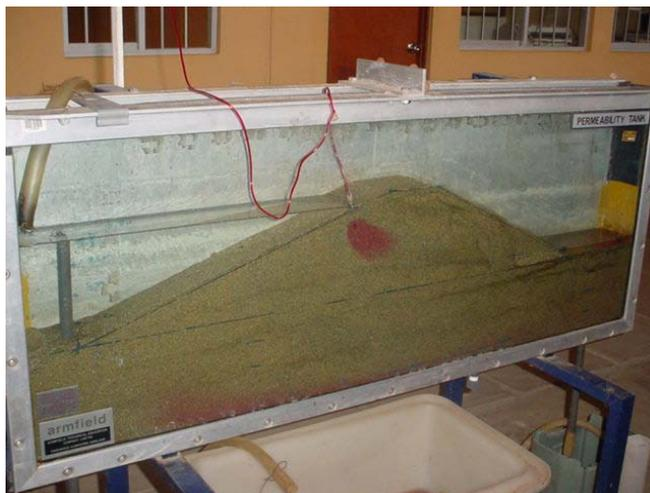
**Foto 3.29** Vista general del ensayo de la presa de tierra con filtro horizontal de 18.375 cm.
