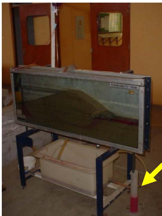
**Foto 3.10** Medición del caudal de filtración.
