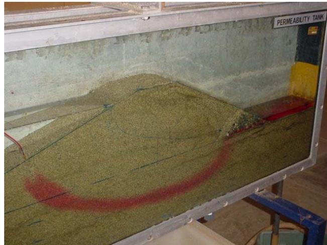
**Foto 3.28** Línea de flujo aguas arriba en dirección al filtro.
