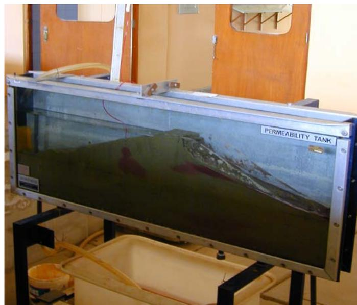
**Foto 3.13** Falla en el talud aguas abajo de la presa.
