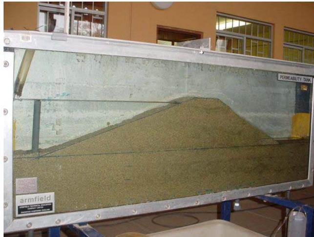
**Foto 3.32** Vista general del ensayo de la presa de tierra con filtro horizontal de 14.41 cm.
