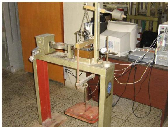
**Foto 3.6** Vista del ensayo de corte directo.
