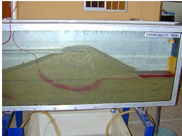
**Foto 3.22** Línea de flujo aguas arriba en dirección al filtro.
