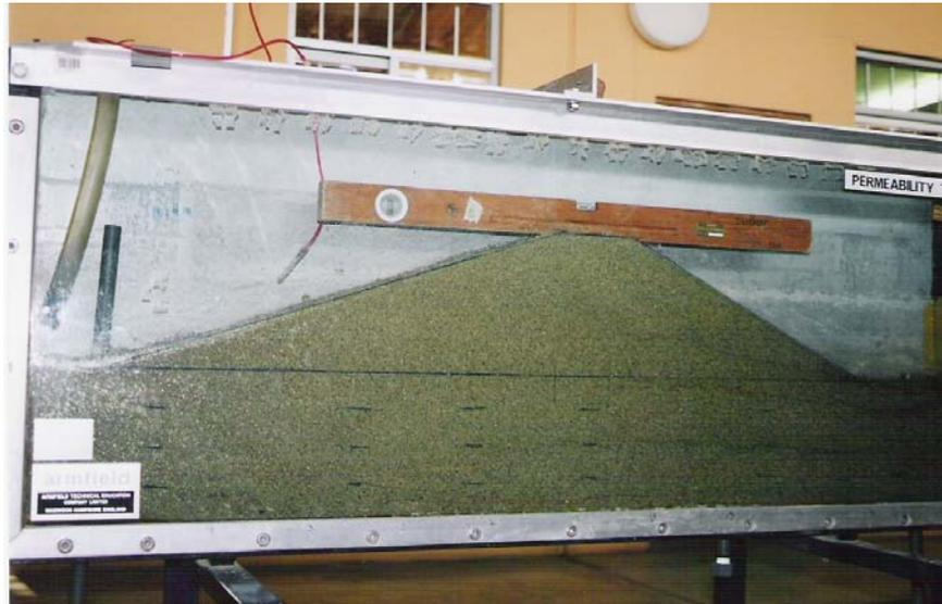
**Foto 3.17** Vista general del ensayo de la presa de tierra con suelo 2, E 1:60 sin filtro.
