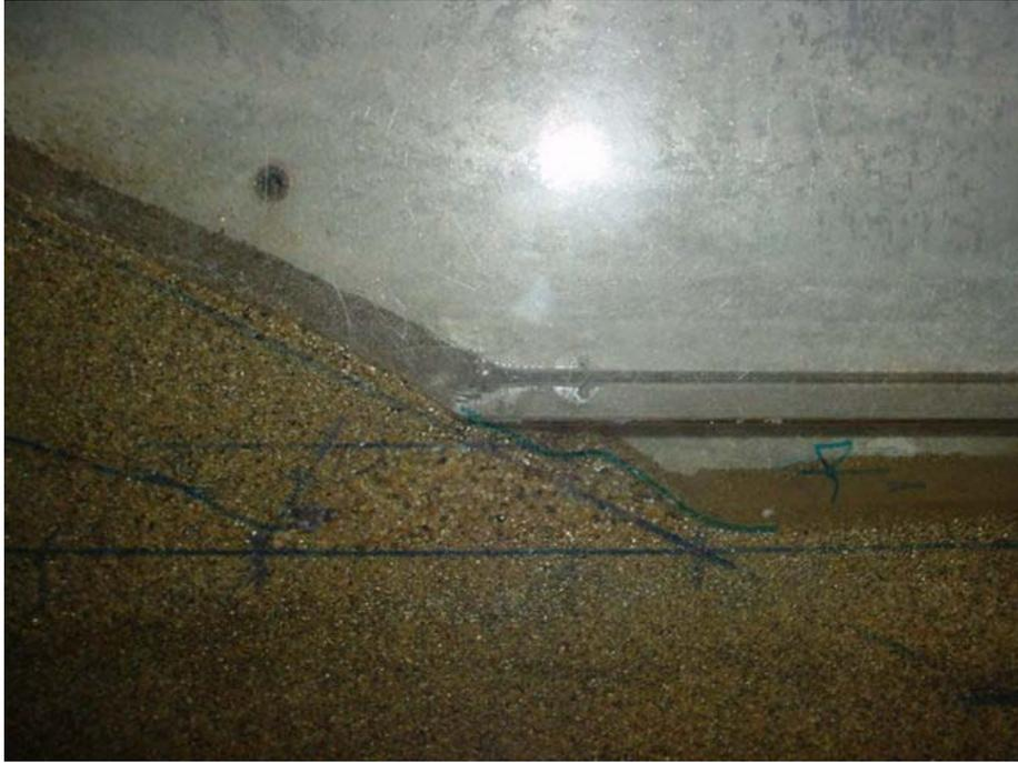
**Foto 3.31** Detalle de la falla en el talud aguas abajo de la presa.
