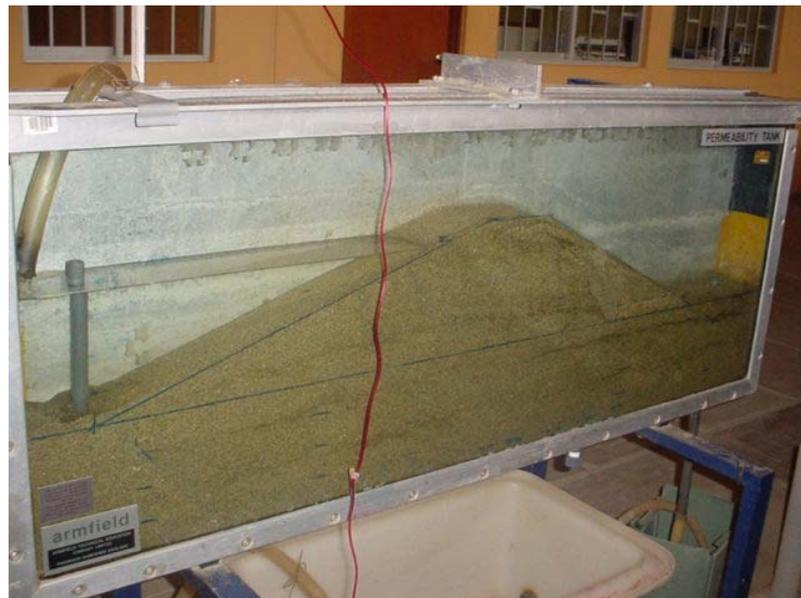
**Foto 3.23** Vista general del ensayo de la presa de tierra con filtro horizontal aguas abajo.
