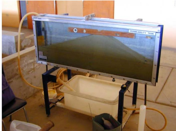
**Foto 3.11** Vista general del ensayo de la presa de tierra con arena fina sin filtro.
