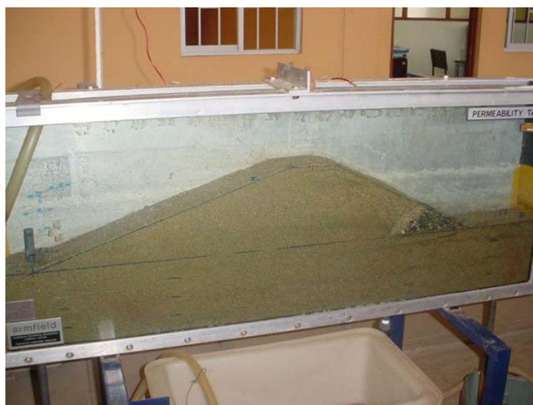
**Foto 3.26** Vista general de l ensayo de l a presa de tierra con filtro tipo enrocado.
