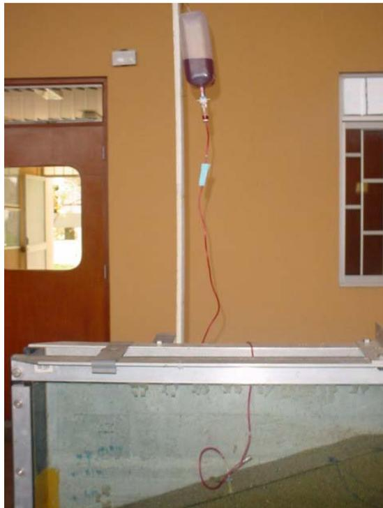
**Foto 3.7** Equipo de inyección de tinte.
