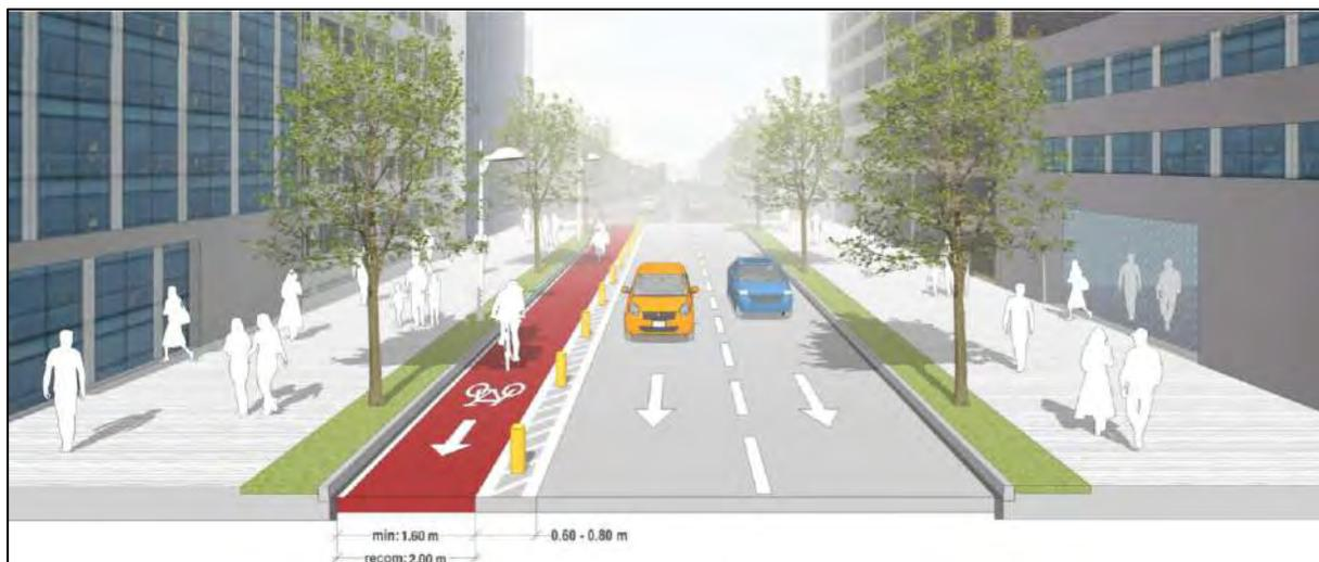
Figura 36. Esquema de una ciclovía unidireccional
