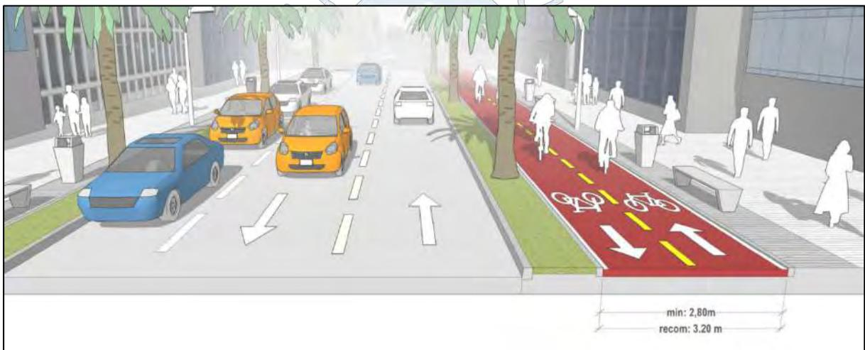
Figura 39. Esquema de una cicloacera bidireccional
