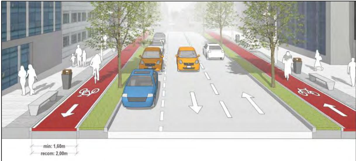
Figura 38. Esquema de una cicloacera unidireccional
