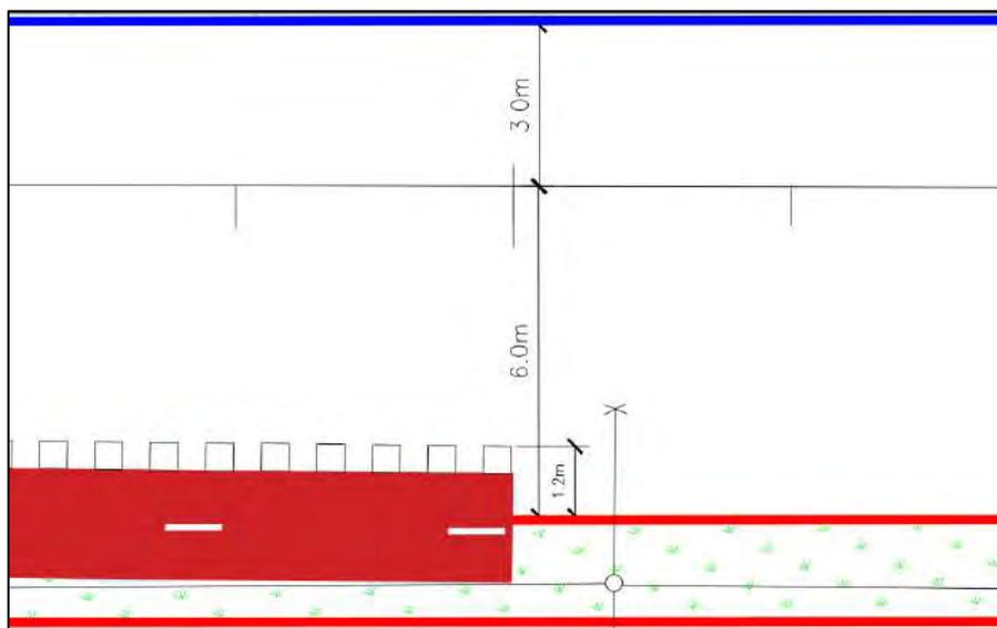
Figura 84. Reducción del carril de la calzada auxiliar debido a la ciclovía izquierda
