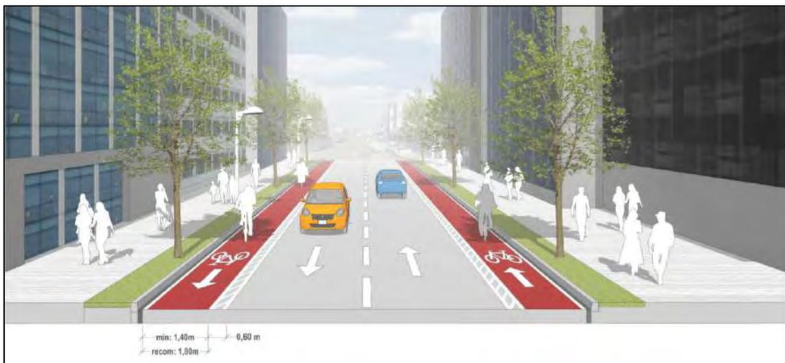
Figura 35. Esquema Ciclocarril
