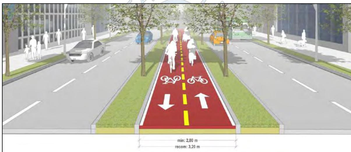
Figura 37. Esquema de una ciclovía unidireccional
