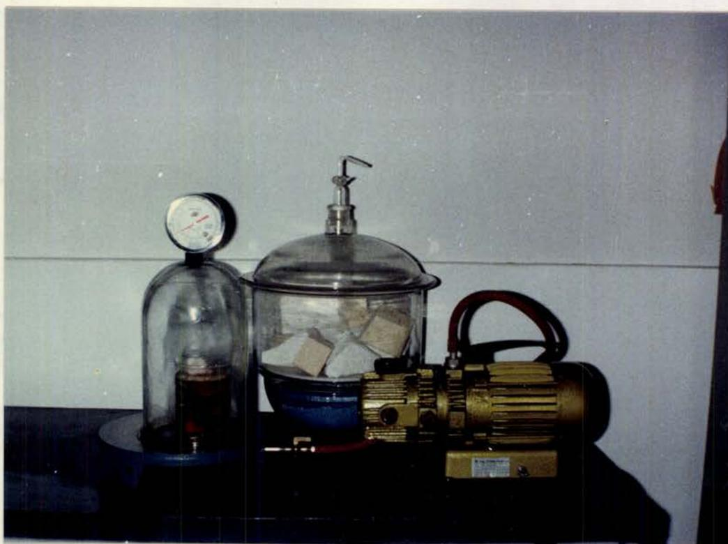
Fig. 5.9. Disposición del equipo durante la Fase de Saturación de la probeta, según Norma UNE 61.034-75.
