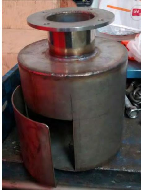
Figura 2.19. Depósito de cenizas.
