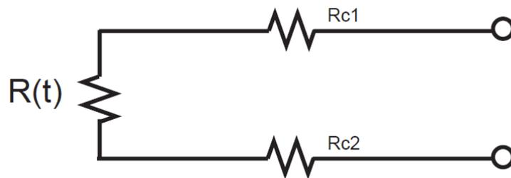
Figura 2.68. Esquema de conexión con 2 hilos [12].
