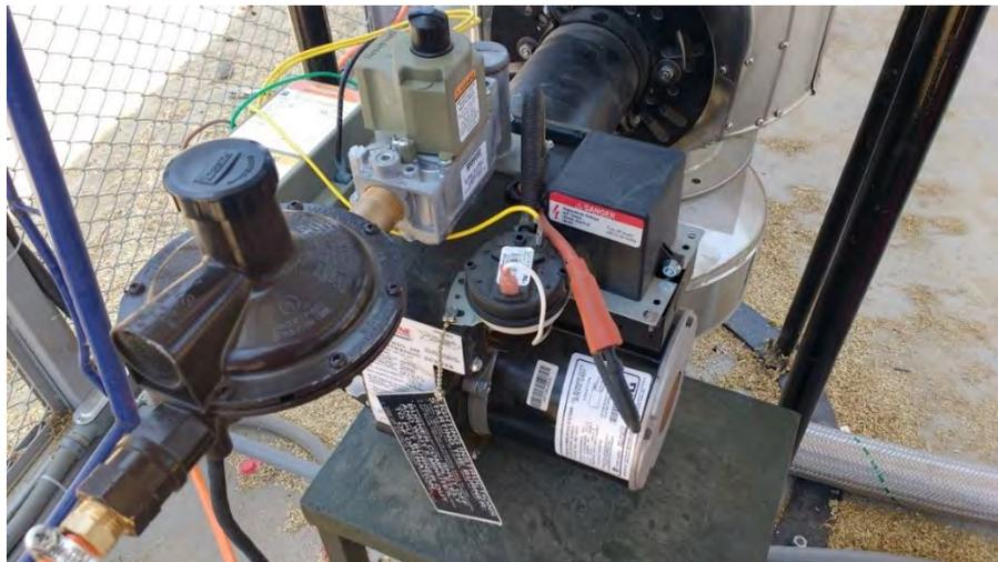
Figura 2.58. Subsistema quemador instalado y acoplado al gasificador.
