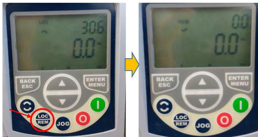
Figura 3.16. Cambio del modo manual al modo remoto del variador del soplador.
