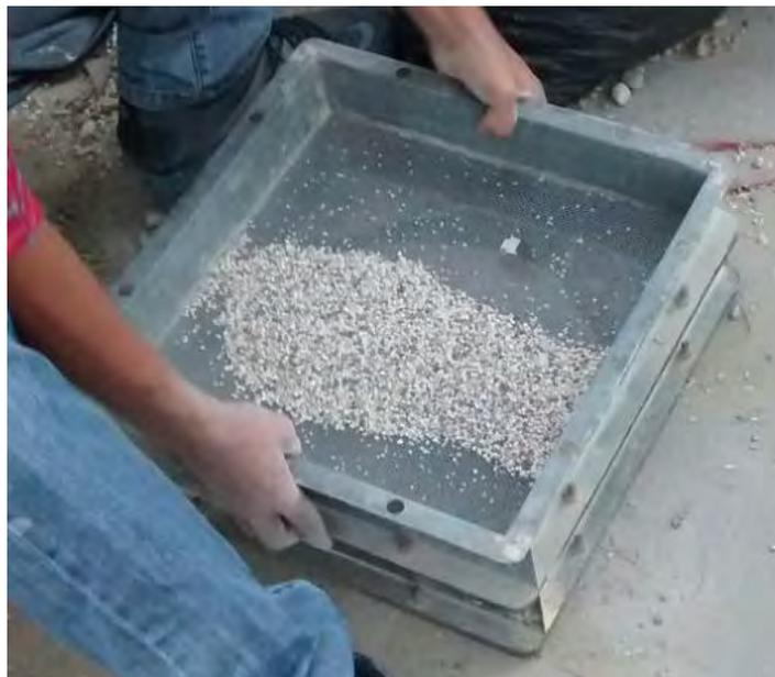
Figura 3.7. Proceso de tamizado del material inerte.
