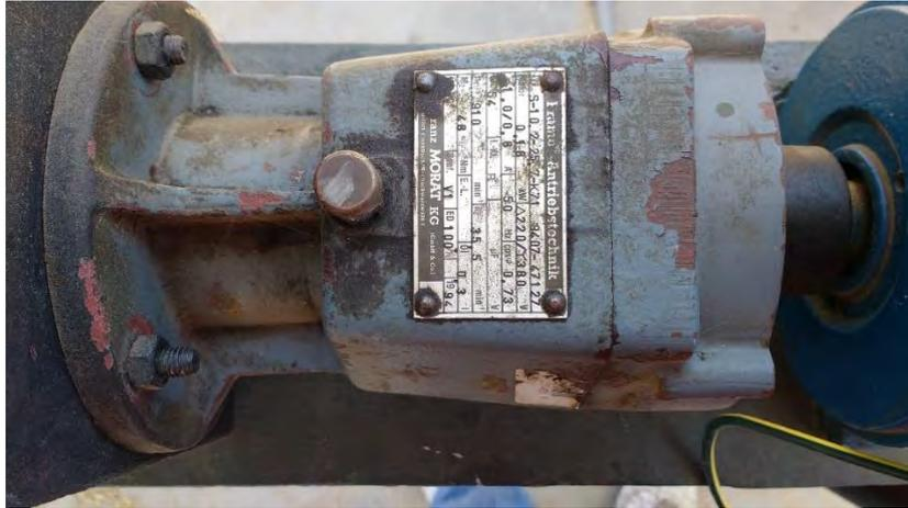
Figura 2.51. Reductor de velocidad mecánico entre el motor y el tornillo sin fin.
