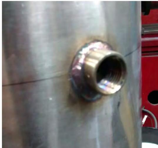
Figura 2.20. Entradas con roscado hembra para los sensores de temperatura.
