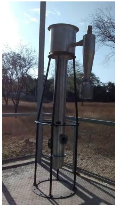
Figura 2.22. Cuerpo del gasificador y soporte instalados.
