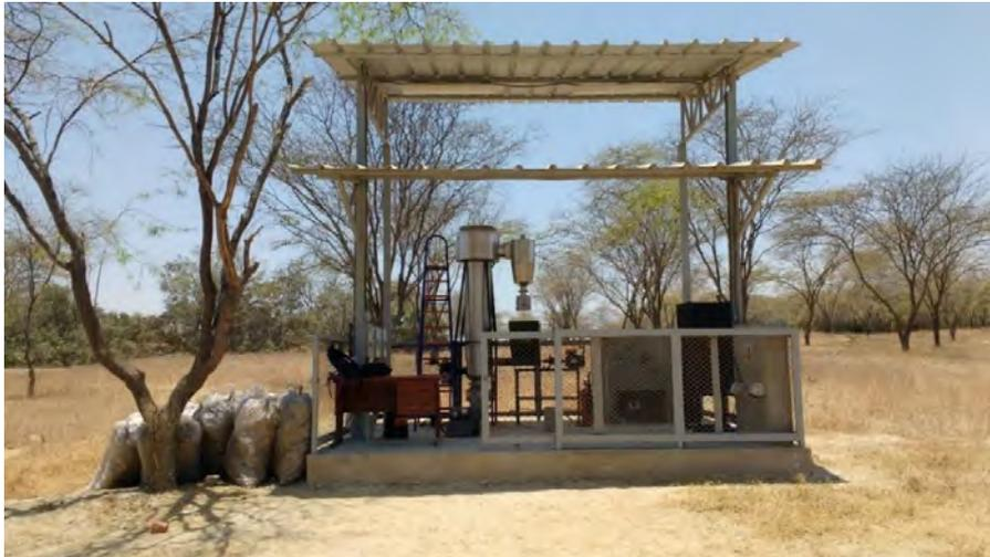
Figura 2.61. Planta gasificador de lecho fluidizado instalada.
