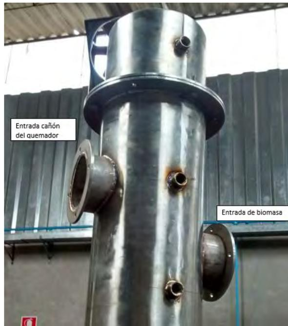
Figura 2.21. Entradas con brida para llama del quemador y biomasa.
