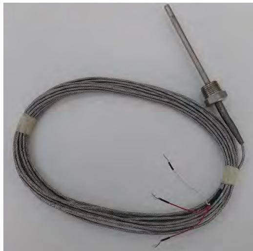
Figura 2.31. Sensor pt 100 adquirido para el proyecto.
