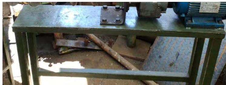
Figura 2.48. Mesa soporte del subsistema dosificador.
