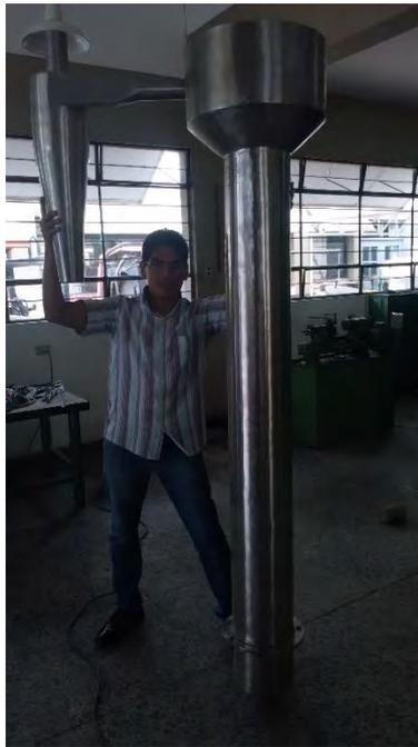
Figura 2.4. Cuerpo del gasificador real.
