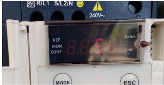
Figura 3.12. Mensaje que por defecto debe aparecer en el display del variador al ser encendido.
