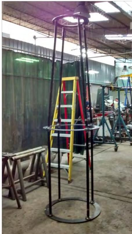
Figura 2.8. Soporte construido para el gasificador.
