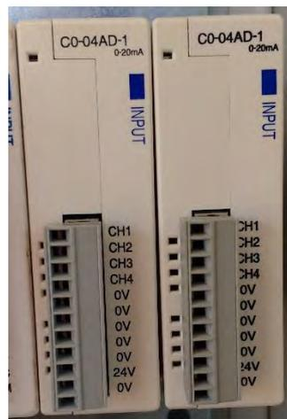
Figura 2.40. Módulos A/D para adquisición de datos con valores entre 0-20 mA.
