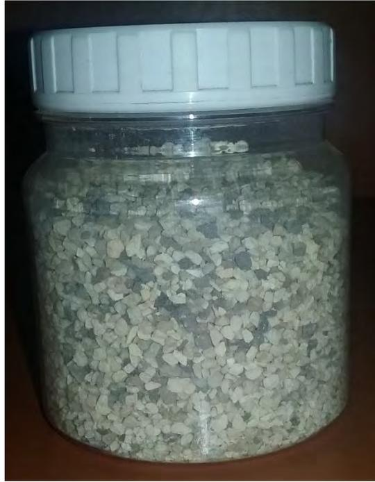
Figura 3.1. Muestra de bauxita, material inerte.
