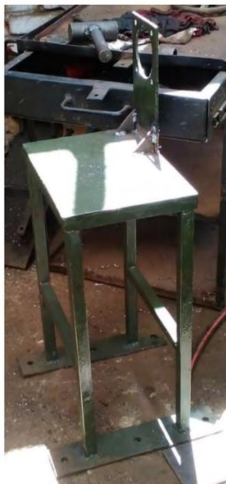
Figura 2.56. Mesa soporte del subsistema quemador.
