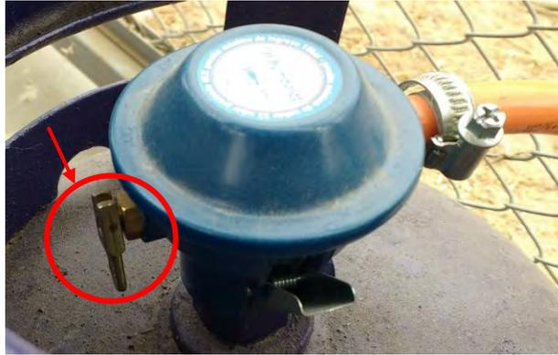
Figura 3.4. Posición de válvula cerrada del balón de gas.
