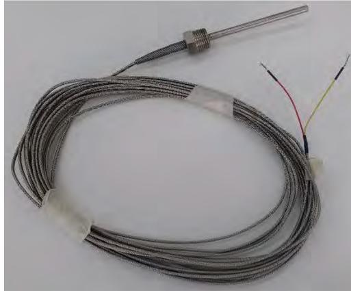
Figura 2.32. Termocupla tipo k adquirido para el proyecto.
