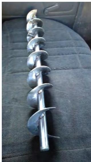
Figura 2.50. Tornillo sin fin del subsistema dosificador.
