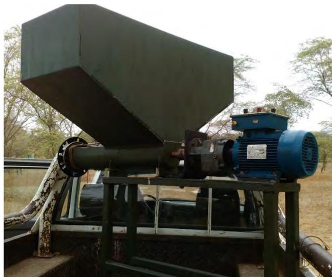
Figura 2.54. Subsistema dosificador de biomasa completo.
