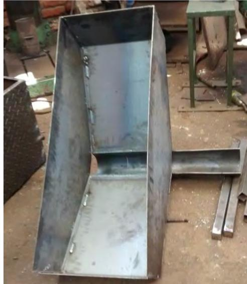
Figura 2.49. Tolva del subsistema dosificador.
