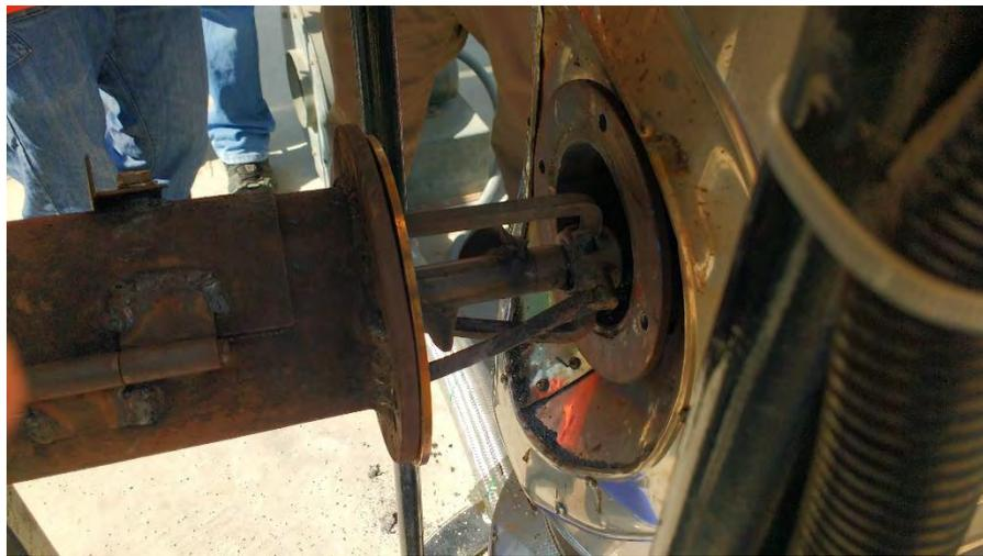
Figura 4.2. Torcedura del soporte del eje del subsistema dosificador.
