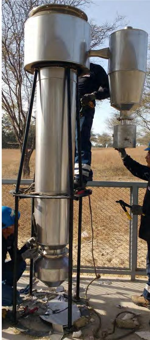
Figura 2.25. Cuerpo del gasificador con cubierta aislante totalmente instalada.
