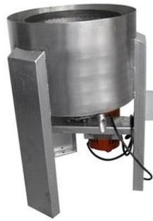
**Ilustración 14. Centrifuga automática para frituras.**
