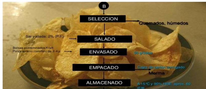
**Ilustración 3: Proceso para la obtención de nachos salados**
