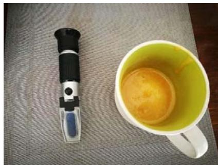
Figura 5 Medición de los grados Brix de la esencia.
