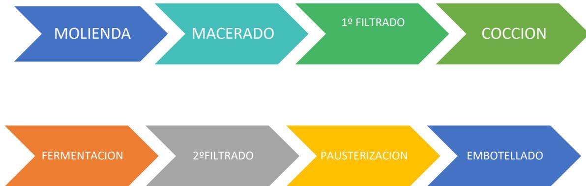
El molino debe estar regulado para garantizar que los granos se aprovechen al máximo a la hora de obtener el mosto. La maceración requiere un control sensorial para garantizar que no hay partículas sólidas así como un control del PH. El filtrado solo tiene el objetivo de impedir que partículas no deseadas pasen a la siguiente etapa. La cocción por su parte necesita controles de temperatura ya que suponen una parte importante de la receta.
