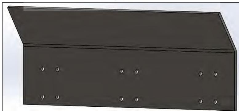
Figura 16. Modelado 3D de la aleta del elevador
