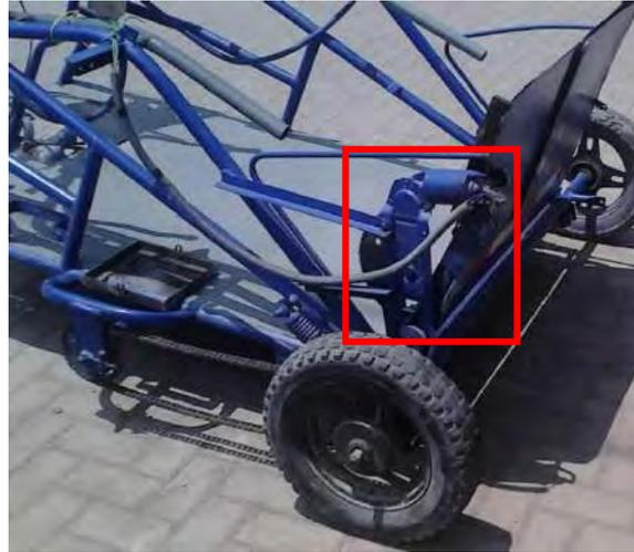
**Figura 116.** Fotografía del mecanismo de engranajes para levante de rampa de ingreso.
