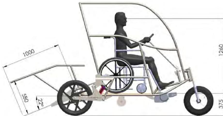
**Figura 111.** Medidas de diseño. Vista frontal. TRIDISC.
