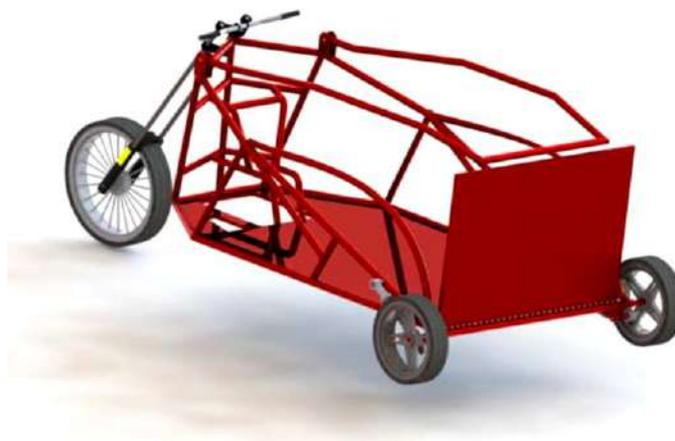
**Figura 14.** Vista isométrica-Diseño SolidWorks Tridisc
