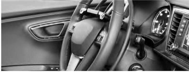
**Figura 5.** Vehículo para discapacitados, adaptación de acelerador y freno en volante.
