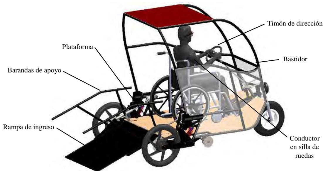
**Figura 41.** Detalle técnico de vehículo propuesto.
