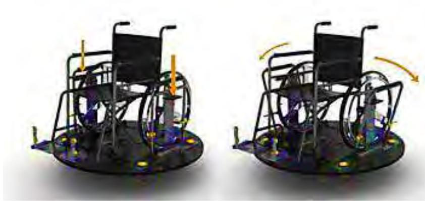
**Figura 67.** Mecanismo de seguridad del vehículo.
