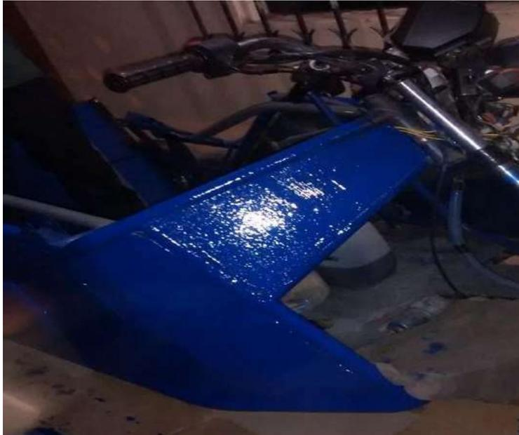
**Figura 18.** Fibra de vidrio colocada sobre el prototipo.
