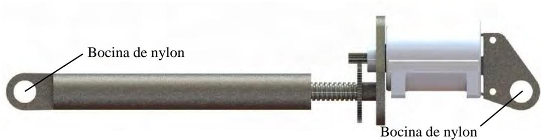
**Figura 146.** Esquema de accionador lineal.
