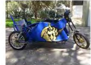
Mejoramiento de la seguridad y fijación de la silla de ruedas. Incorporación de señales de luz. Cambio de tamaño de llantas y reubicación del motor para reducir la altura del CG.
