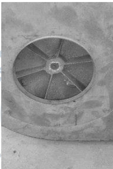
Figura 16. Soplador del Gasificador UDEP
