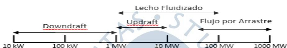
Figura 2. Rango de aplicación de los gasificadores para la producción de energía eléctrica
