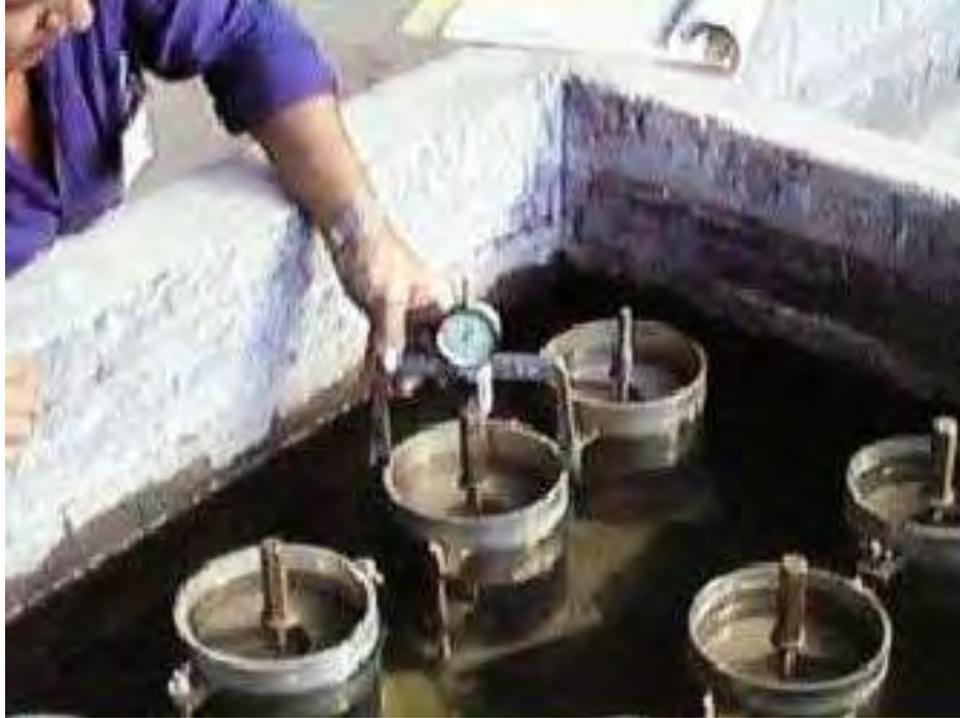
**Figura 5.** Muestras de suelo en condición de inmersión de 4 días para el CBR
