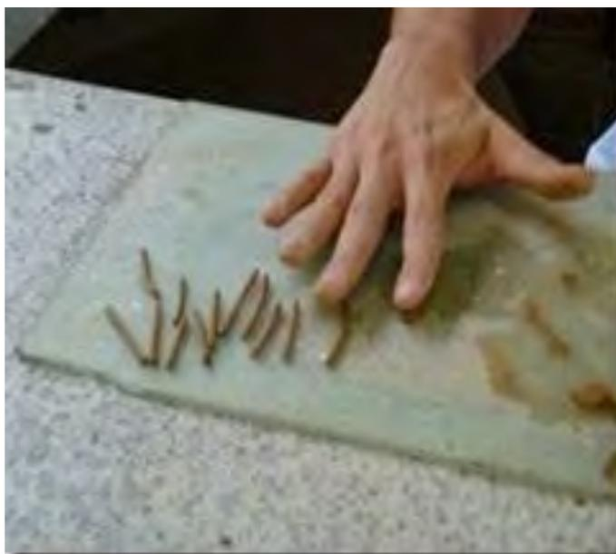
**Figura 9.** Ensayo de plasticidad
