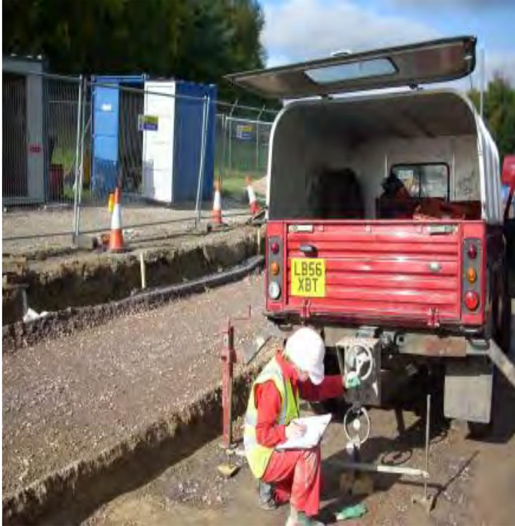
**Figura 2.** Ensayo del CBR en campo
