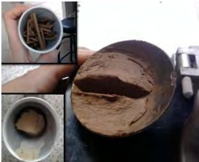
**Figura 8.** Ensayo de Casagrande para determinar el Límite Líquido
