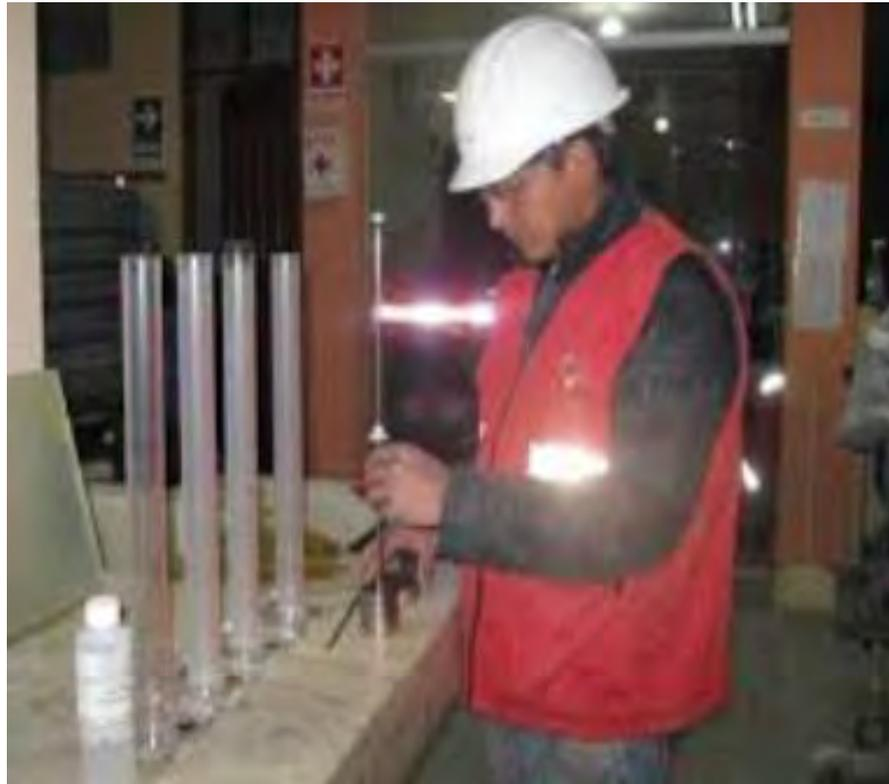
**Figura 10.** Ensayo de equivalente de arena
