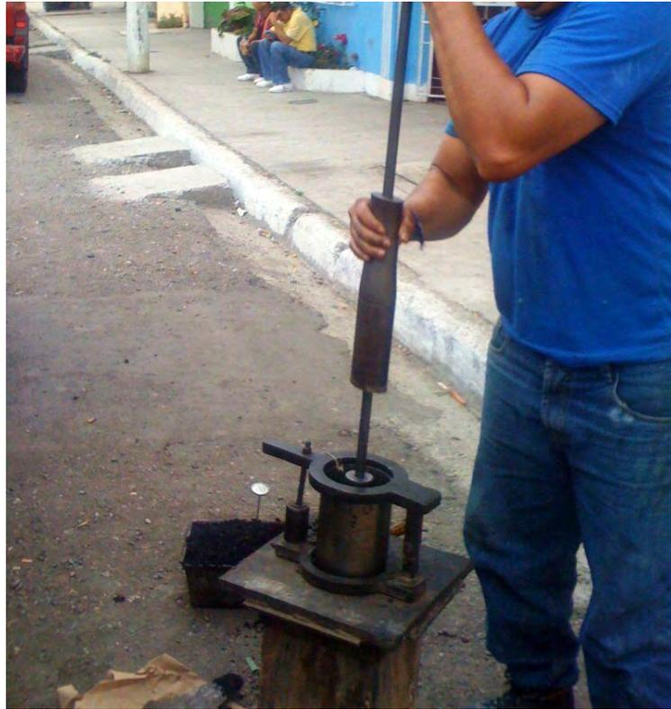
**Figura 12** Ensayo de Proctor
