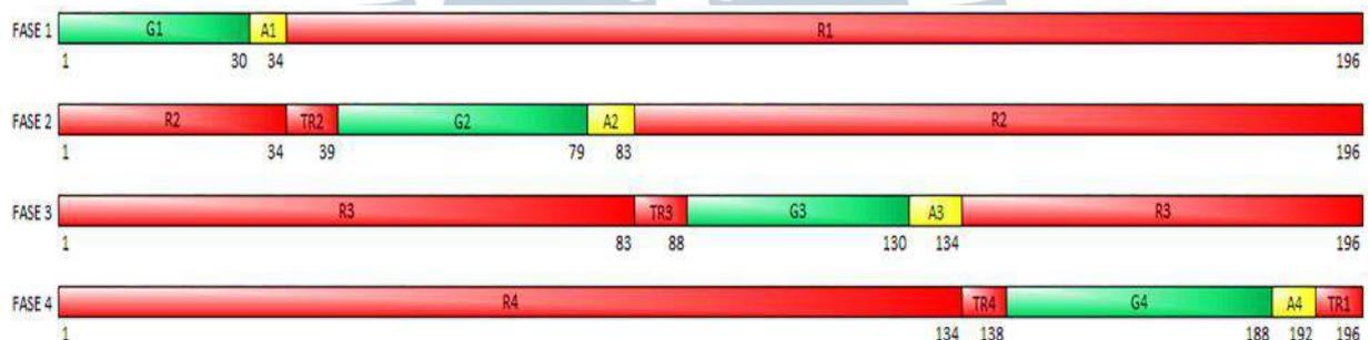
Figura 39. Distribución semafórica seleccionada después de las diversas iteraciones para ajustar del ciclo semafórico
