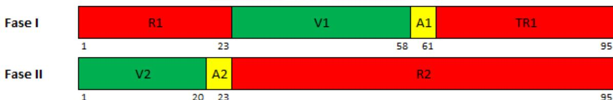
Figura 25. Diagrama de fases semafóricas de la intersección actual
