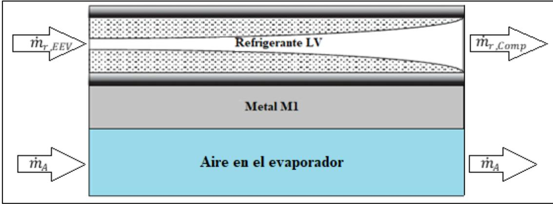
Figura 17. Esquema del evaporador durante modo 1 de operación.
