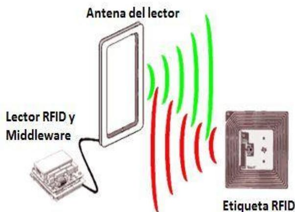
**Figura 14** Antena con lectora RFID
