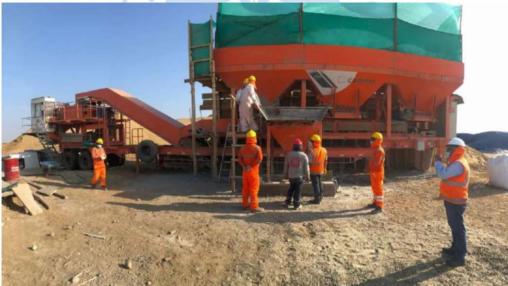
Figura 35. Planta de suelos de tambor rotatorio, usada en el presente trabajo de investigación.
