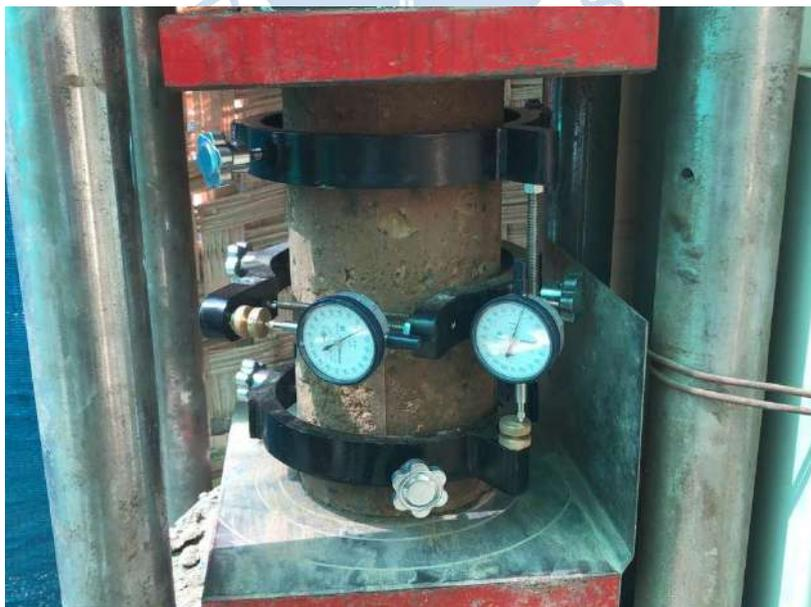
Figura 27. Probeta de suelo cemento de 6x12" con diales de deformación.
