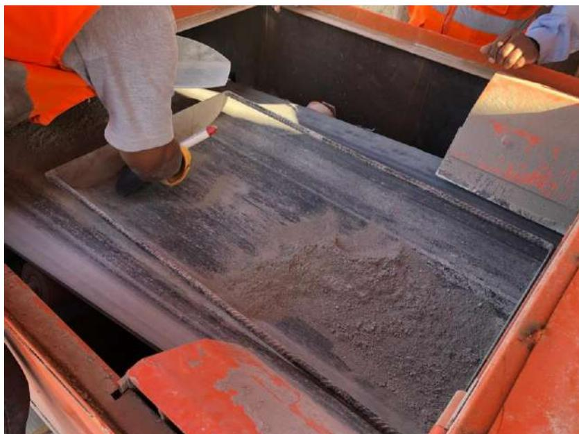
Figura 47. Control diario de contenido de cemento en faja transportadora con cuadrante metálico.
