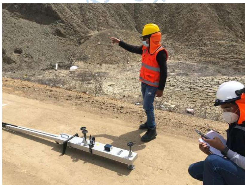
Figura 62. Medición deflectométrica con Viga Benkelman, km 13+200.
