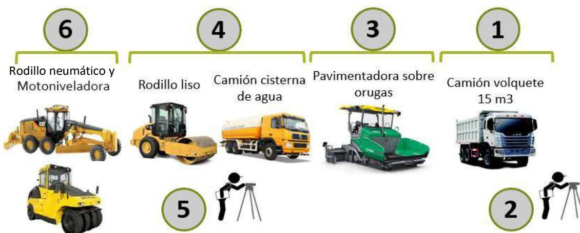
Figura 39. Equipos usados durante el procedimiento completo de producción de suelo cemento.
