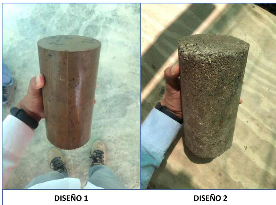
Figura 29. Verificación visual de probetas de 4x8" para diseños 1 y 2.
