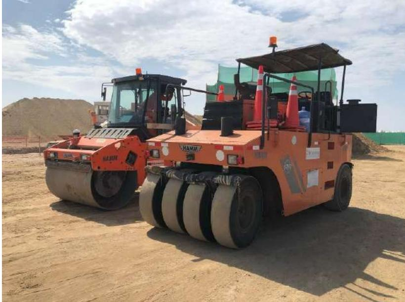
Figura 44. Rodillo liso y rodillo neumático utilizados para compactación de suelo cemento
