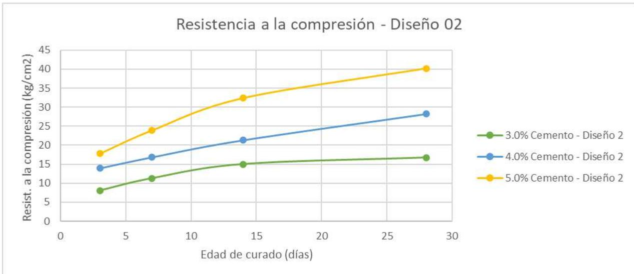
Figura 26. Evolución de la resistencia a la compresión a través del tiempo - Diseño 2
