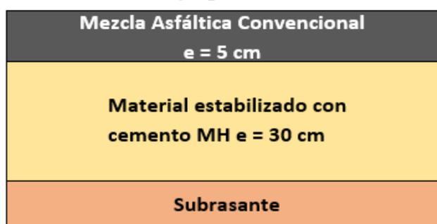
Figura 15. Paquete estructural propuesto para el tramo II.
