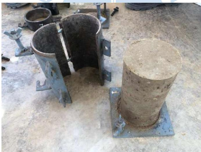
Figura 24. Probeta desmoldada después de 24 horas de reposo.
