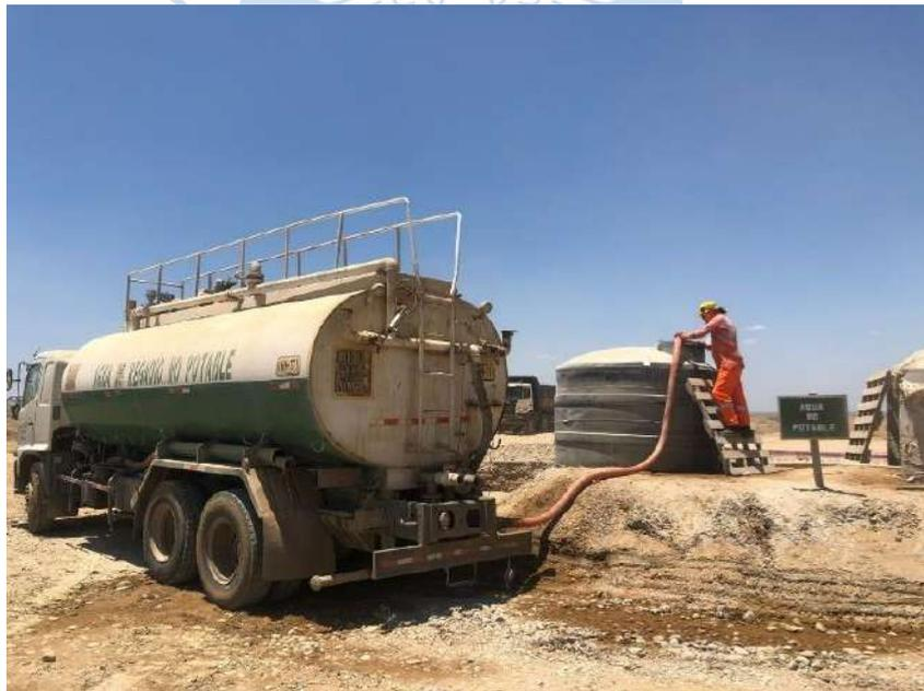
Figura 38. Abastecimiento de agua en tanques estacionarios de 10,000 litros de capacidad.
