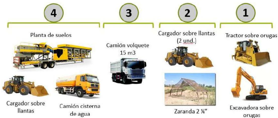
Figura 33. Equipos usados durante el procedimiento completo de producción de suelo cemento.
