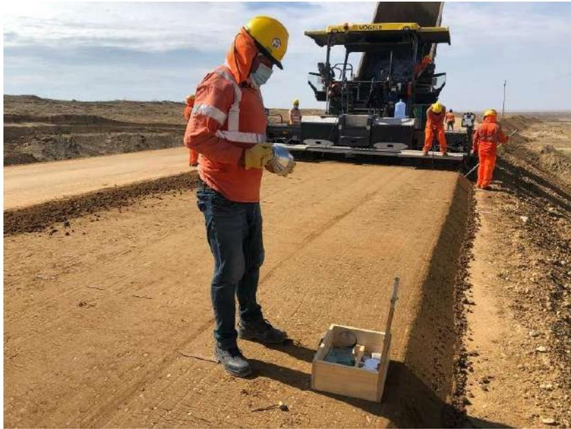
Figura 49. Medición de contenido de humedad en suelos método del carburo de calcio – MTC E 126
