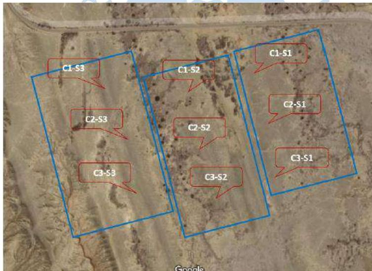
Figura 10. Distribución de calicatas realizadas en cantera Portachuelos 2.
