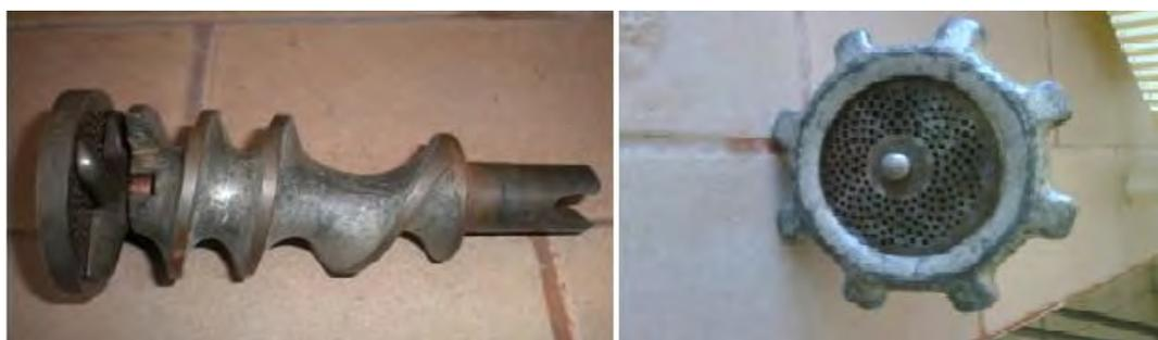
**Figura 36.** Tornillo helicoidal, placa circular perforada, tuerca de sujeción
