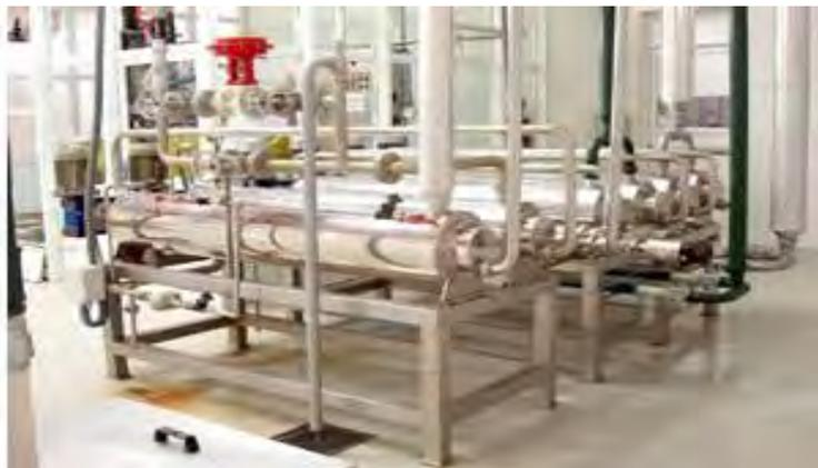
**Figura 29.** Pasteurizadores de superficie raspada
