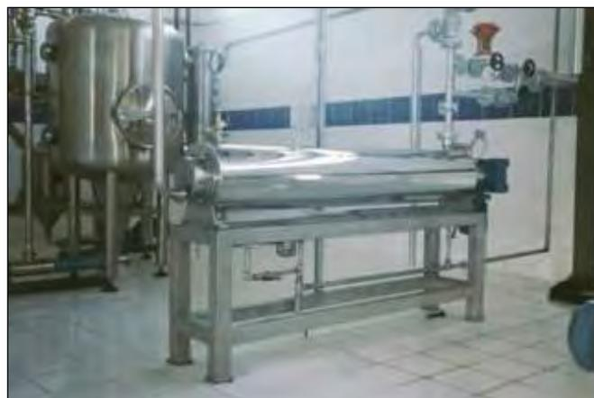
**Figura 52.** Inactivador enzimático de superficie raspada
