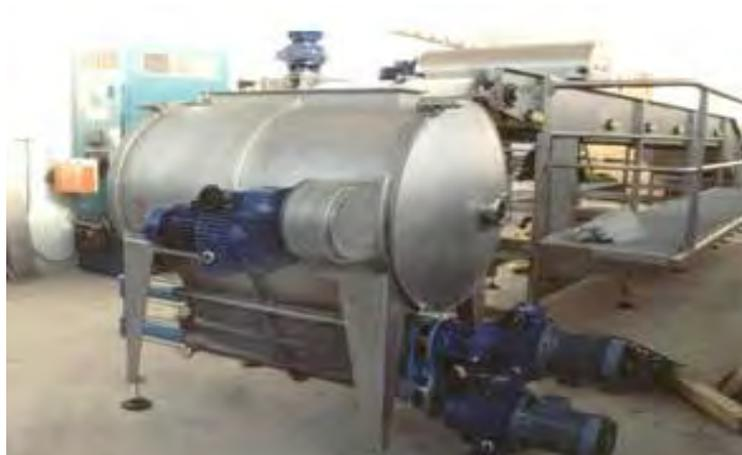
**Figura 25.** Pulpeadora a vacío
