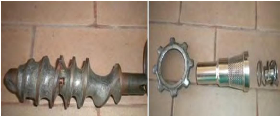
**Figura 34.** Tornillo helicoidal, accesorio cónico con agujeros y tuerca de sujeción
