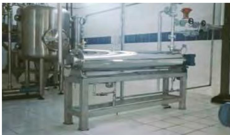
**Figura 26.** Inactivador enzimático de superficie raspada
