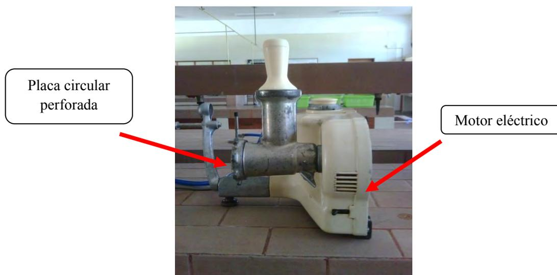
**Figura 35.** Molino de carne con placa circular perforada accionado por motor eléctrico
