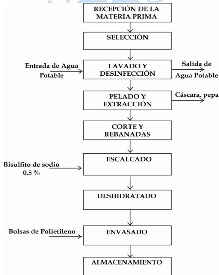
**Imagen 1 Diagrama de flujo del proceso**
