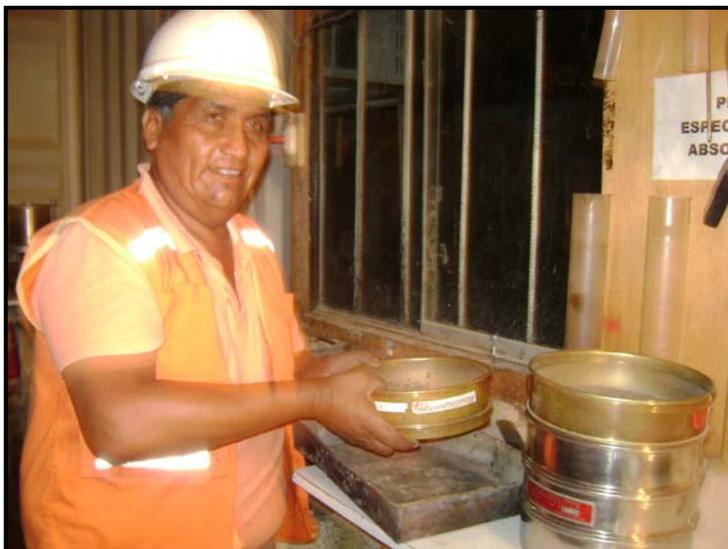
Foto 2.21 Tamizado del agregado
