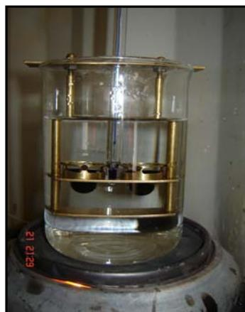
**Foto 1.8 Aplicación de la temperatura durante el proceso de calentamiento del asfalto**
