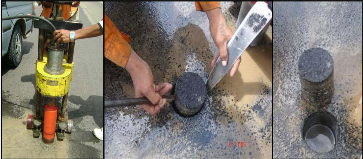
Foto 4.1 Extracción de diamantinas
