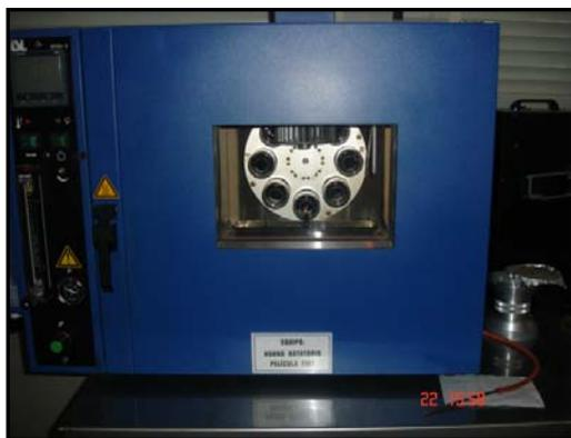
Foto 1.10 Horno con plataforma rotativa
