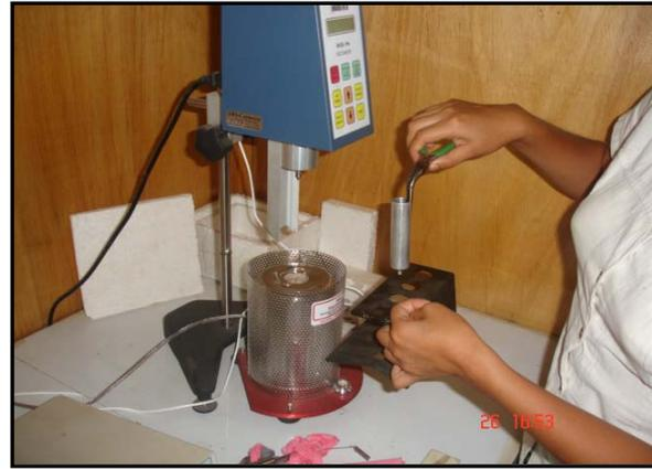
Foto 1.19 Colocación de la cámara en el viscosímetro
