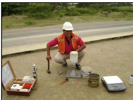
Foto 2.19 Colocación del frasco de arena en el orificio
