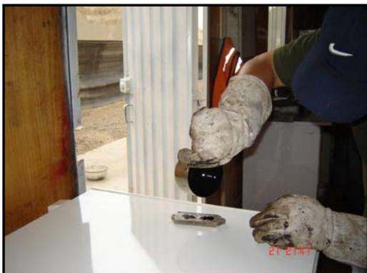
**Foto 1.5 Preparación de la probeta para empezar el ensayo de ductilidad**
