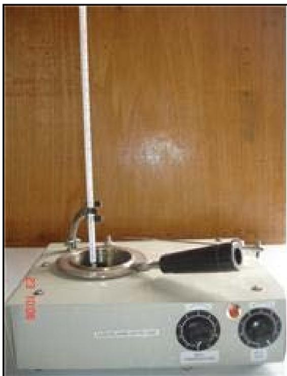
Foto 1.3 Equipo para realizar el punto de inflamación
