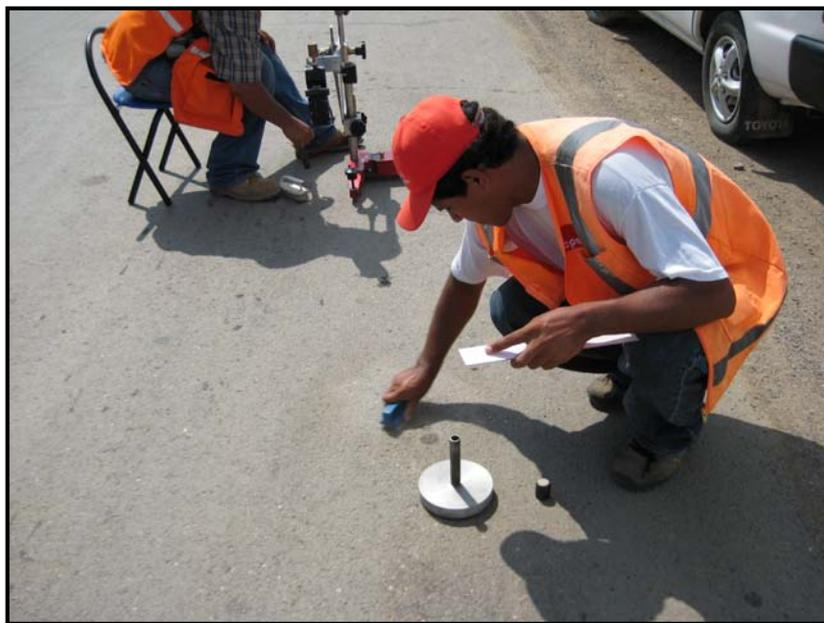
Foto 4.5 Ensayo del círculo de arena
