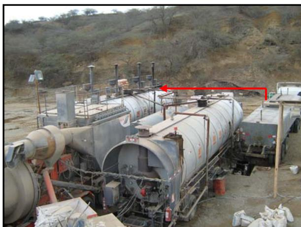
**Foto 1.25 Transferencia del asfalto base al tanque de modificado**
