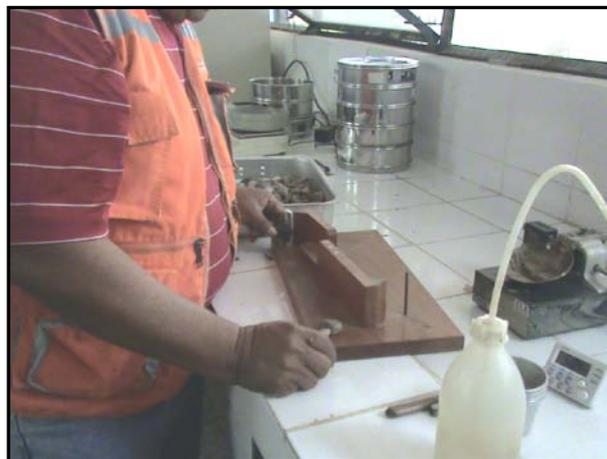
**Foto 2.28 Clasificación de los agregados según su forma**
