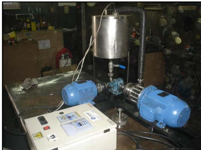
Foto 1.2 Molino Coloidal: equipo de laboratorio para el proceso de modificación
