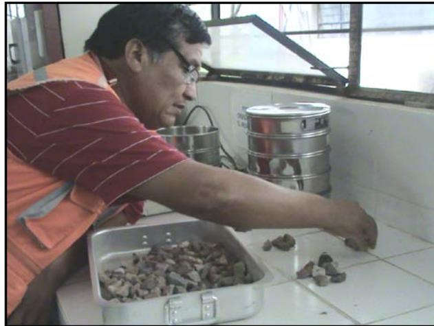
**Foto 2.27 Selección de los tipos de agregados según su forma**
