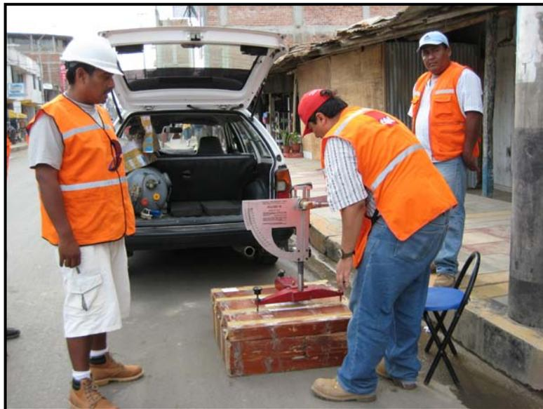
Foto 4.4 Ensayo del Péndulo
