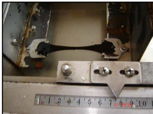
**Foto 1.6 Especímen en proceso de alargamiento durante el ensayo de ductilidad**
