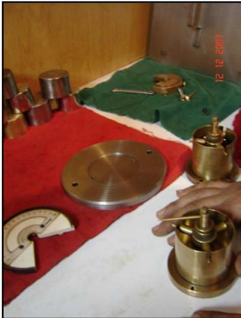
**Foto 1.14 Preparación de la muestra para empezar el ensayo de recuperación elástica torsional**
