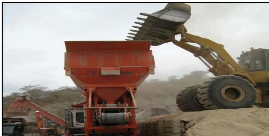
**Foto 1.24 Silos dosificadores de la planta de asfalto**
