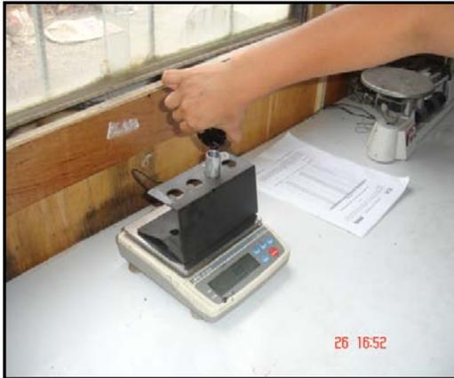
Foto 1.18 Pesar el asfalto en la cámara
