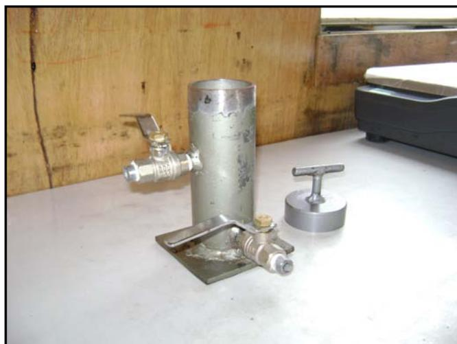
**Foto 1.13 Dispositivo del ensayo de estabilidad al almacenamiento**
