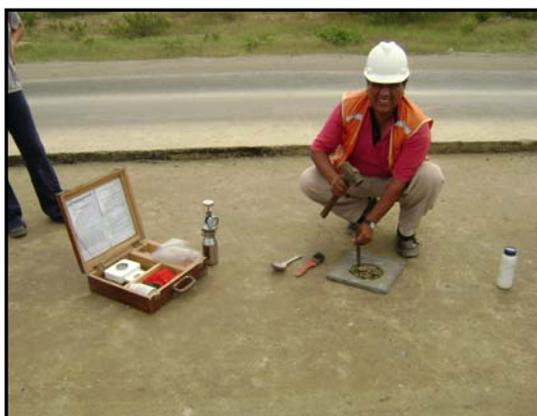
Foto 2.17 Cavar el orificio de ensayo
