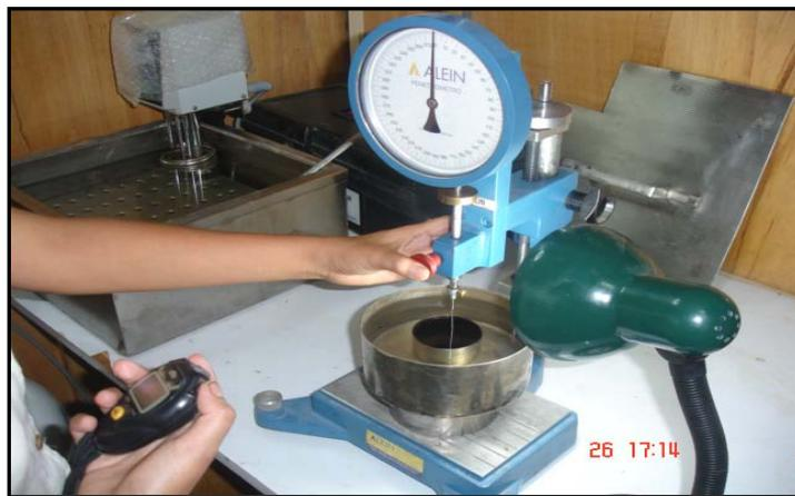
Foto 1.4 Ensayo de Penetración
