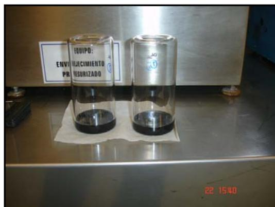
Foto 1.11 Muestras en recipientes de vidrio para el ensayo de envejecimiento
