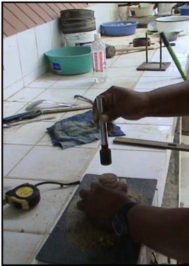
**Foto 2.22 Colocación del agregado fino en el molde cónico**
