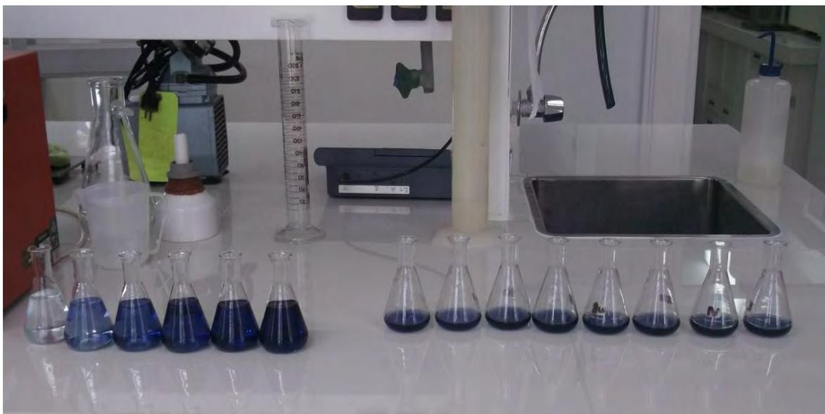
**Figura 2.19.** A la izquierda se muestran los estándares preparados y a la derecha se presentan 8 muestras listas para ser analizadas en el espectrofotómetro.
