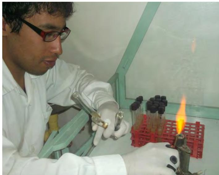
**Figura 2.26.** Esterilización del asa utilizando el mechero de bunsen.
