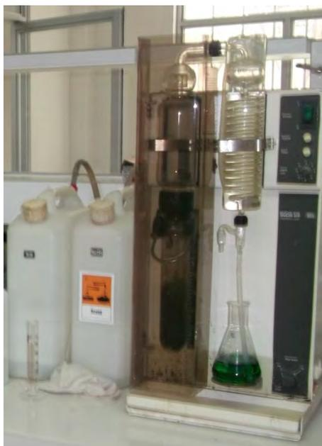
**Figura 2.22.** Destilación de una muestra. Se observa el tubo de digestión y el Erlenmeyer en el Sistema de destilación.
