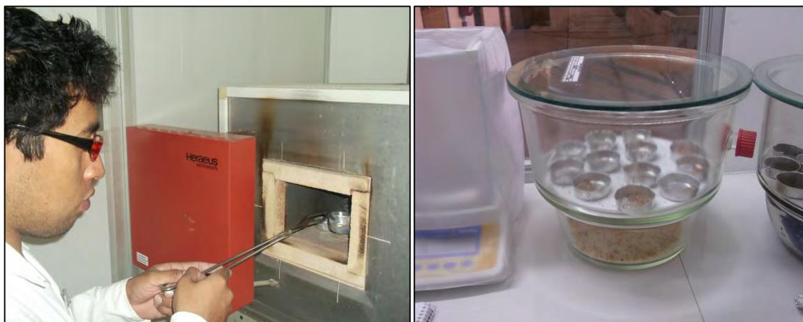
**Figura 2.21.** A la izquierda se sacan las muestras de la mufla y a la derecha se están secando, antes de ser pesadas.
