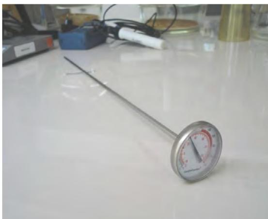
**Figura 2.14.** Termómetro especial para utilizar en la compostera.
