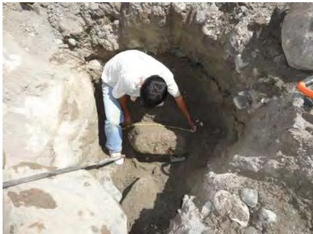
**Foto 15.** Calicata para toma de muestras de sedimentos del río Urubamba
