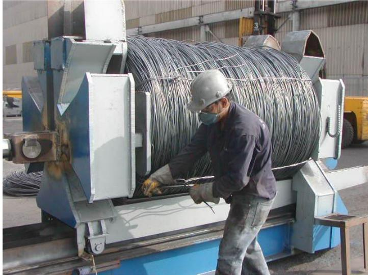
*Fig. 3.3 Prensado de Rollos*
