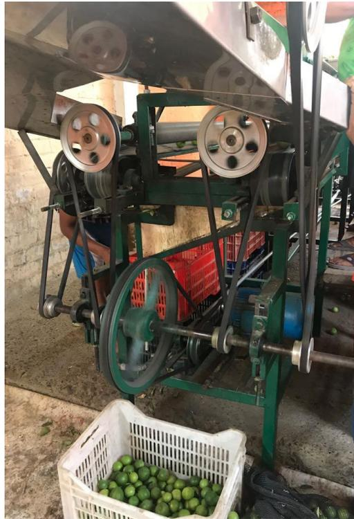
*Figura 24:* Sistema de transmisión del sistema de clasificación por polines.
