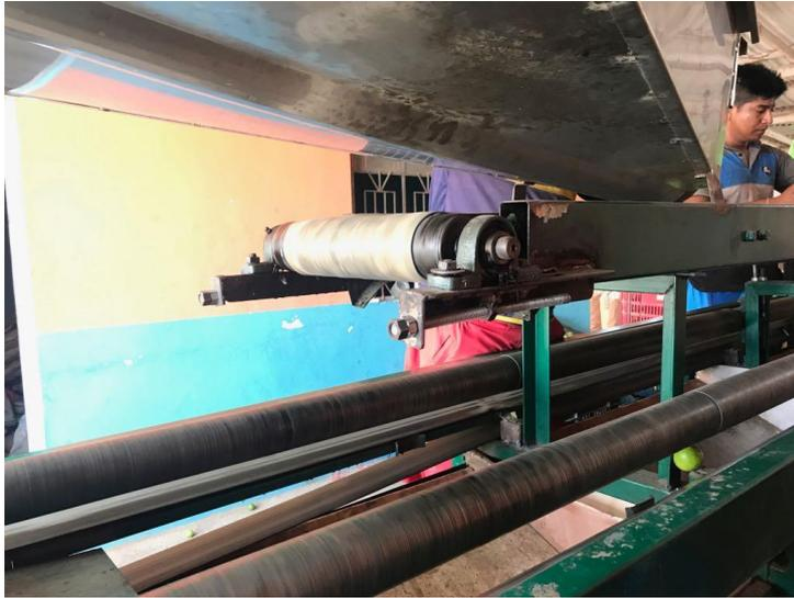
*Figura 23:* Sistema de clasificación por polines, tamaño y color.
