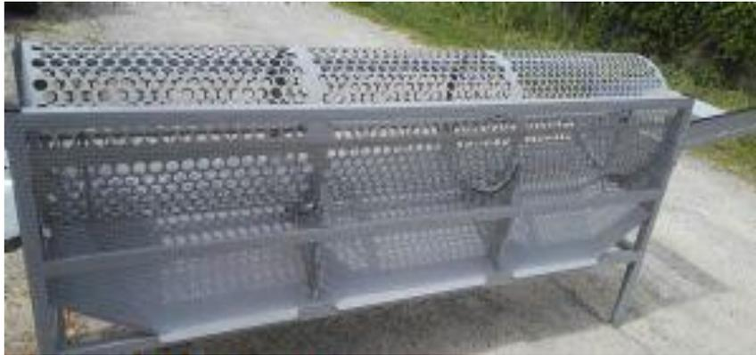
*Figura 25:* Sistema de clasificación por rodillo.
