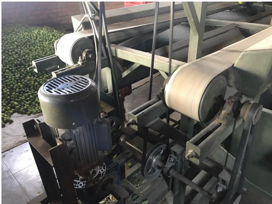
*Figura 20:* Sistema mecánico del sistema de clasificación por polines.
