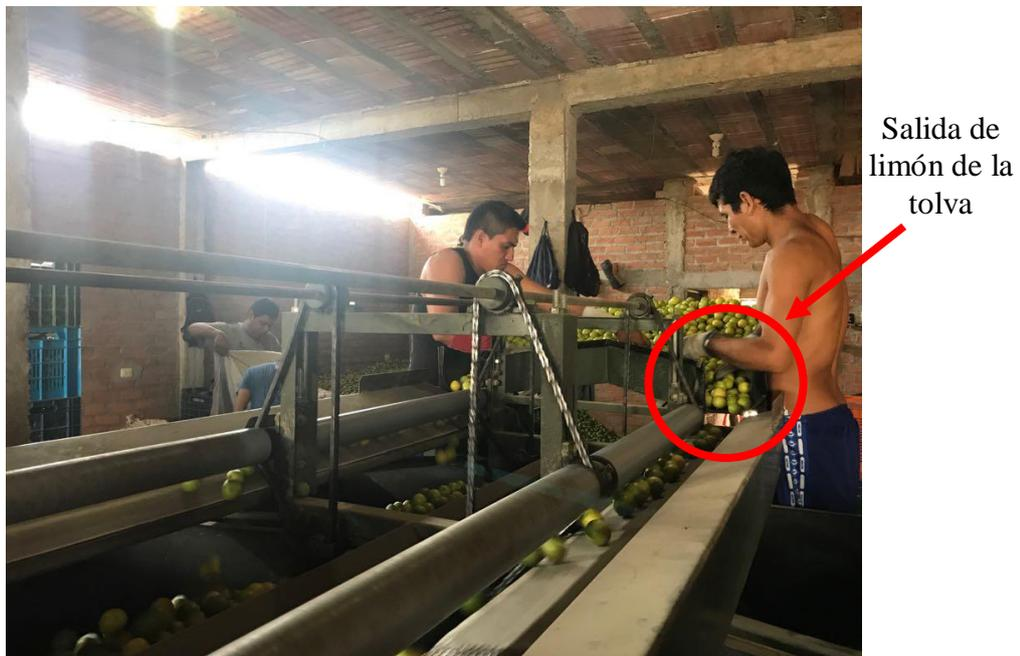
Figura 17: Sistema de clasificación mediante polines.
