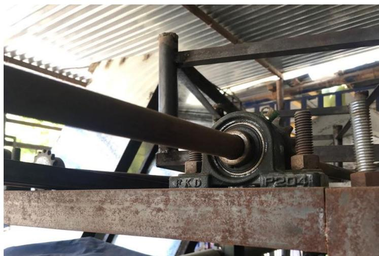
*Figura 22:* Eje de transmisión para el movimiento de los polines.
