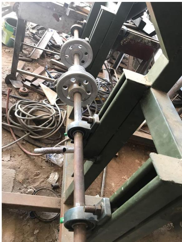
*Figura 21:* Sistema de transmisión, clasificación por polines.
