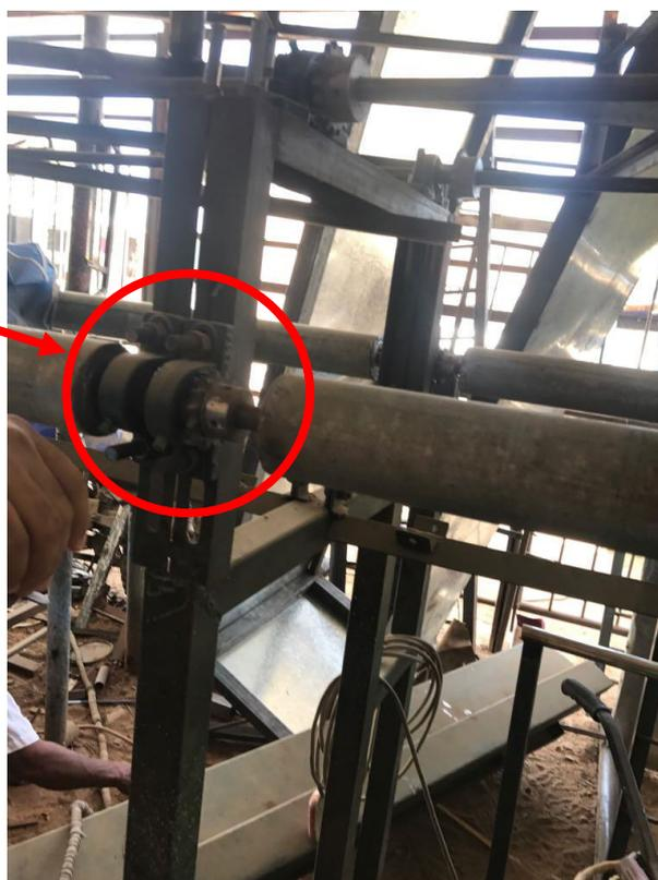
*Figura 18:* Sistema de ajuste de polines.
