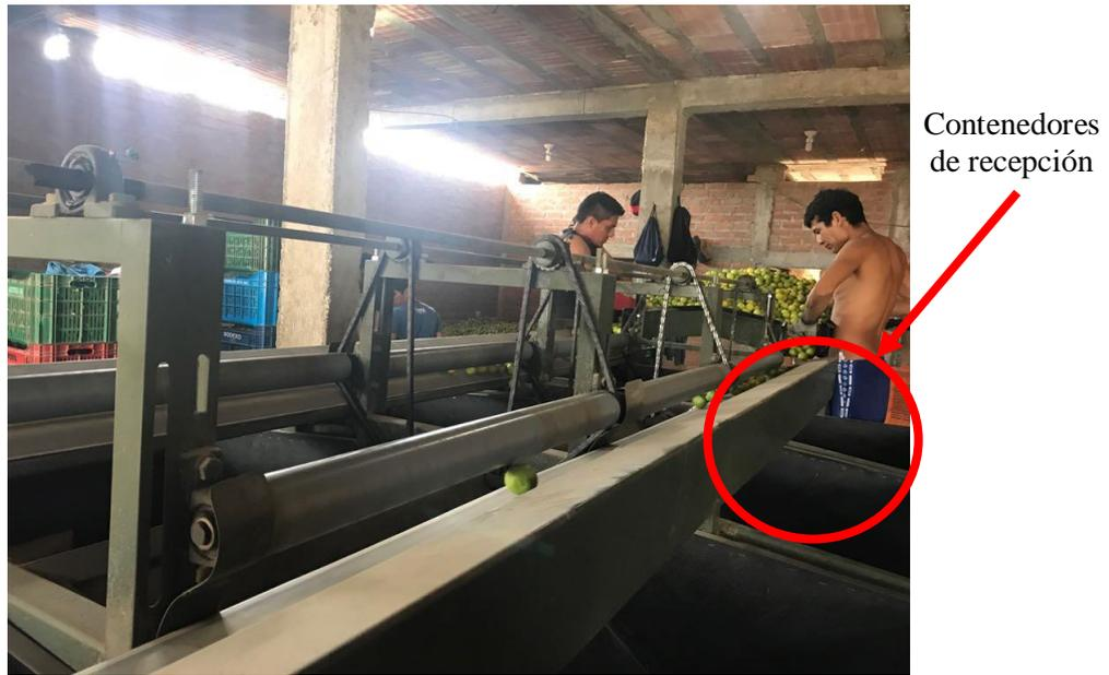
*Figura 19:* Sistema de clasificación por polines.
