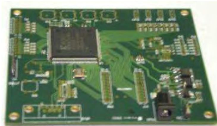
**Fig. 4.23 Tarjeta PCB con integrado FPGA montado**
