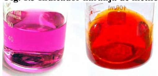
**Fig. 1.4** Fenolftaleína en entorno básico (izq.) y extremadamente ácido (der.)
