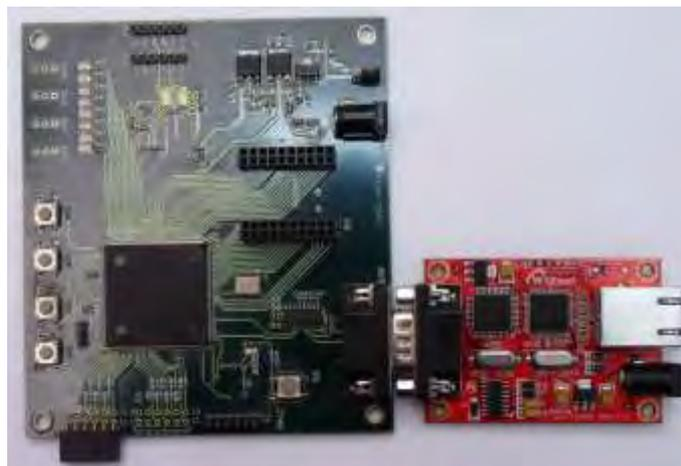
Fig. 4.52 Sistema PCB-FPGA conectado al dispositivo *WizNet*
