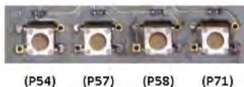
Fig. C.3 Pulsadores de la tarjeta PCB
