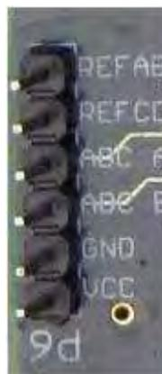
**Fig. C.5 Conector del ADC**
