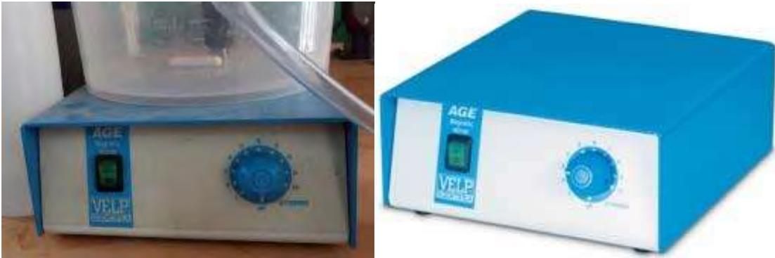
**Fig. 4.58 Agitador magnético**
