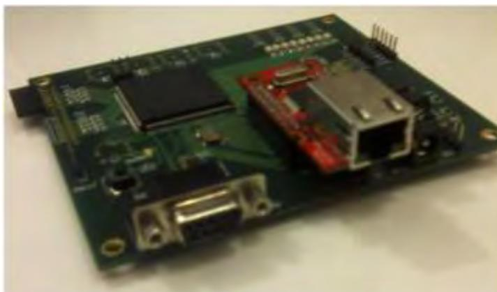
**Fig. 4.26 Vista de la tarjeta FPGA con componente Ethernet montado**
