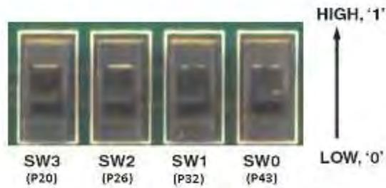
**Fig. C.4 Interruptores deslizantes**
