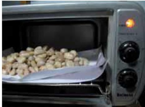
Figura 48. Horno que se usa para medir la humedad para el método de rutina.
