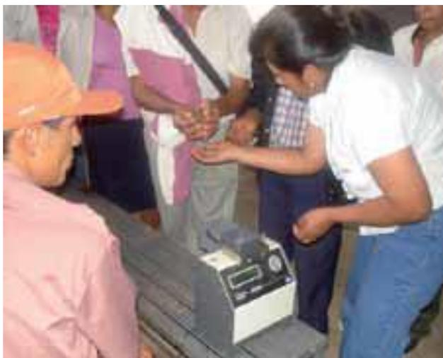
Figura 49. Medidor de humedad electrónico
