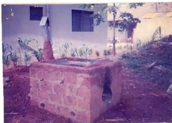
Figura 40. Secador tipo batch para cacao
